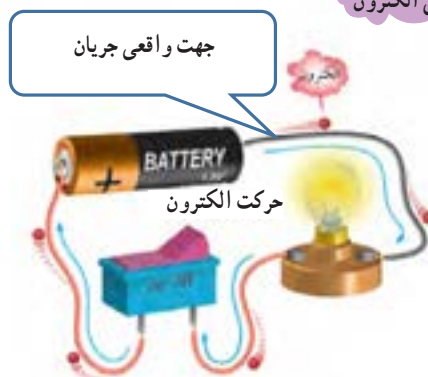
شکل ۱-۲۳- جهت جریان الکتریکی
