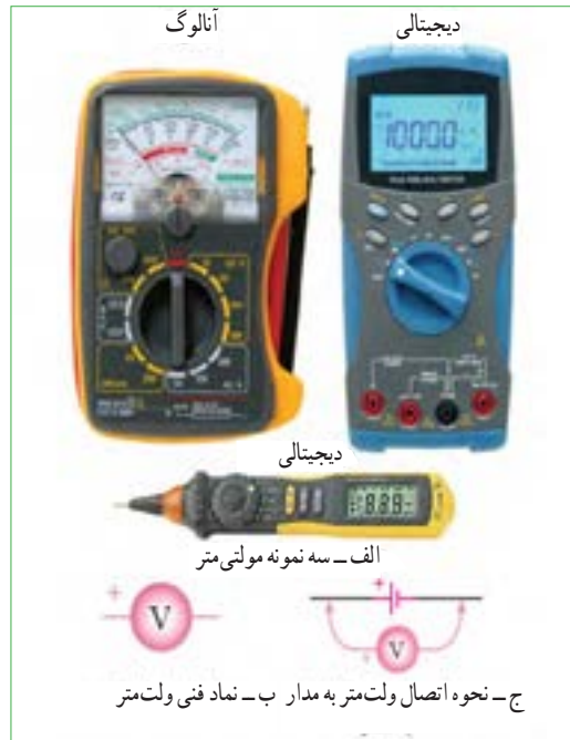
شکل ۵۵-۱- ولت متر و نماد آن
