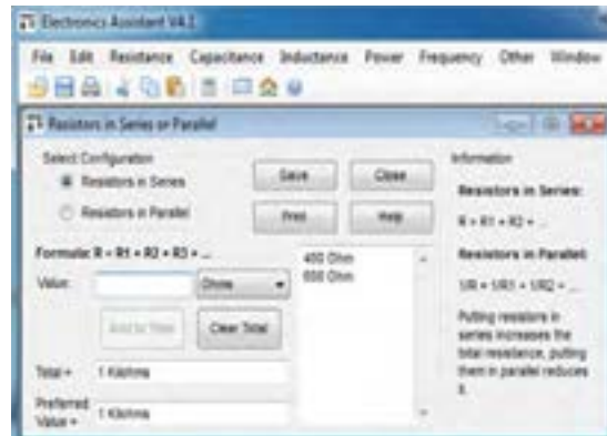
شکل ۷۱- ۱- یک نمونه مثال حل شده در نرم افزار
