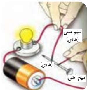
شکل ۱۹-۱- برقراری جریان الکتریکی در هادی
