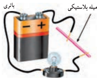
شکل ۲۰-۱- برقرار نشدن جریان الکتریکی در عایق
