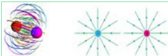
الف - جهت میدان الکتریکی در ذره باردار
