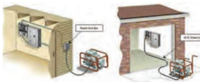
شکل ۱۲- محل اتصال موتور ژنراتور به تابلوی اصلی
