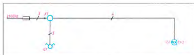
شکل ۳۰ - ۳- شمای فنی مدار کلید دویل
