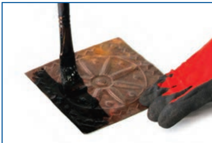
شکل ۱۰-۱۰- آغشته کردن سطح پلاک مسی به قیر
