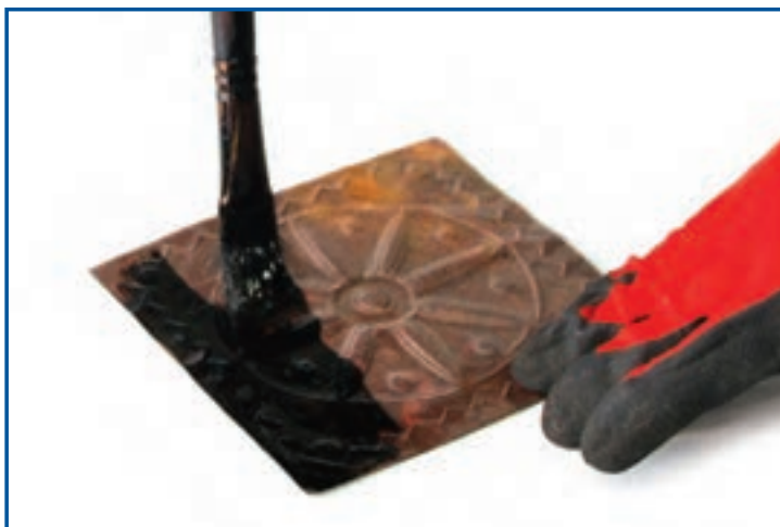
شکل ۱۰-۱۰- آغشته کردن سطح پلاک مسی به قیر
