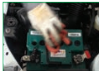
پ - در صورت کم بودن سطح مایع باتری، با پارچهٔ تمیز سطح آن را تمیز کنید.
