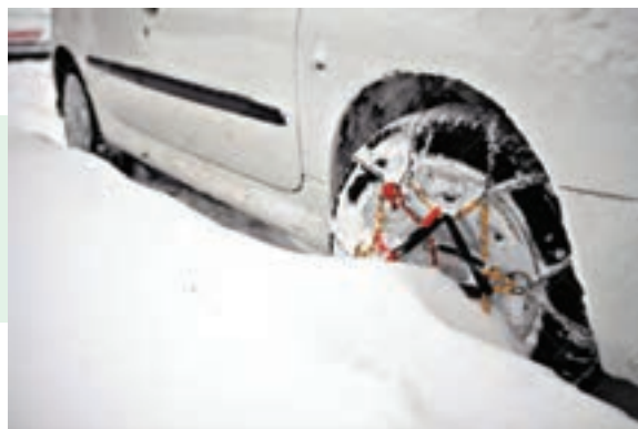
شکل ۸-۲۳ - استفاده از زنجیر چرخ
