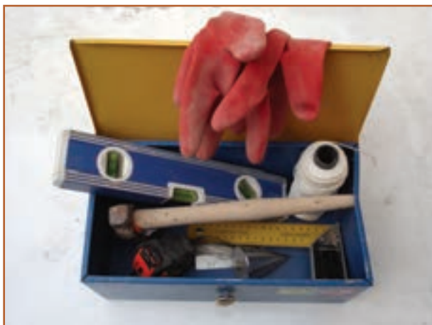
شکل ۱۰-۷- برخی از ابزار مورد نیاز دیوار چینی
