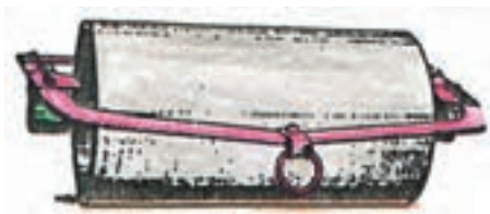
شکل ۵-۳- غلتک معمولی صاف
