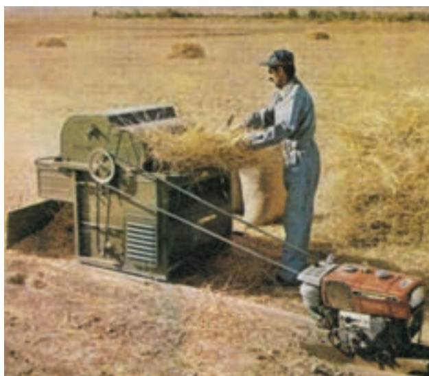
شکل ۱-۲۳- خرمنکوب با موتور تیلر در حال کار
