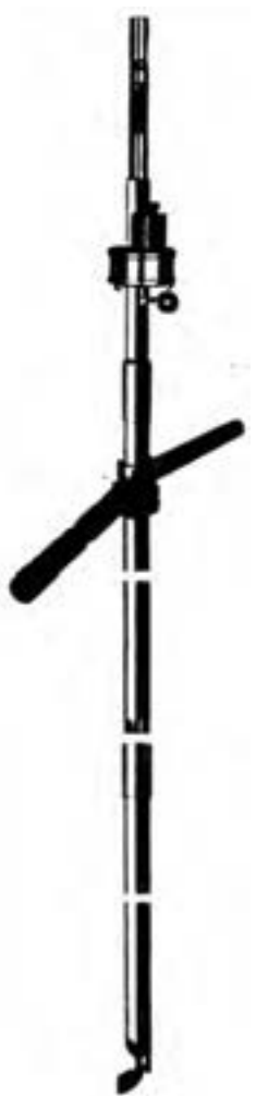
شکل ۵-۳- سوند فستوکسین برای قرص‌گذاری در داخل توده غله
