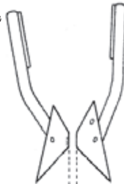
شکاف برای تنظیم تمایل عمودی تیغه
