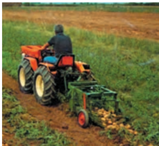
شکل ۱-۲۹- نوع دیگر غده کن در حال کار
