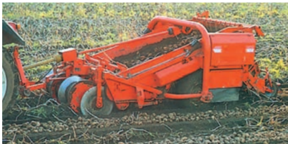
شکل ۱-۲۸- سیب زمینی کن در حال کار
