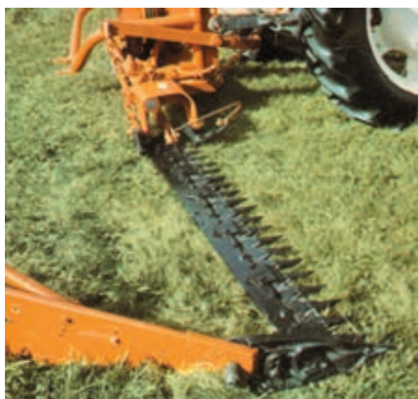
شکل ۱-۸- دروگر شانهای تراکتوری
