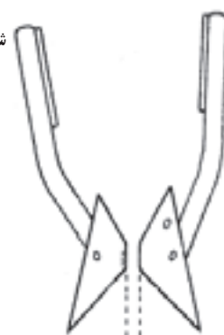
شکاف برای تنظیم تمایل عمودی تیغه
