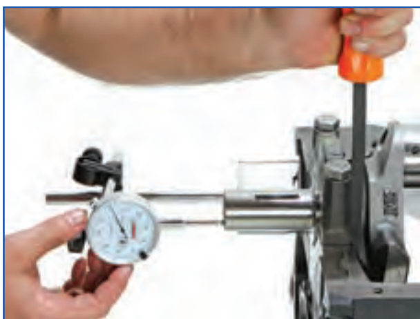
شکل ۱۷۹-۴- اندازه‌گیری لقی طولی میل‌لنگ با ساعت اندازه‌گیری
