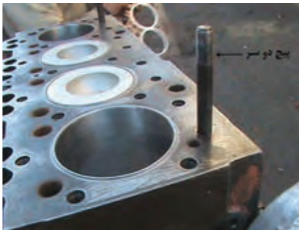
شکل ۱۴۲-۴- محل قرار گرفتن پیچ دو سر روی سیلندر
