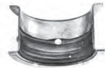
شکل ۱۶۵-۴ خط به دلیل نفوذ ذرات ریز و درشت بین میل‌لنگ یاتاقان
