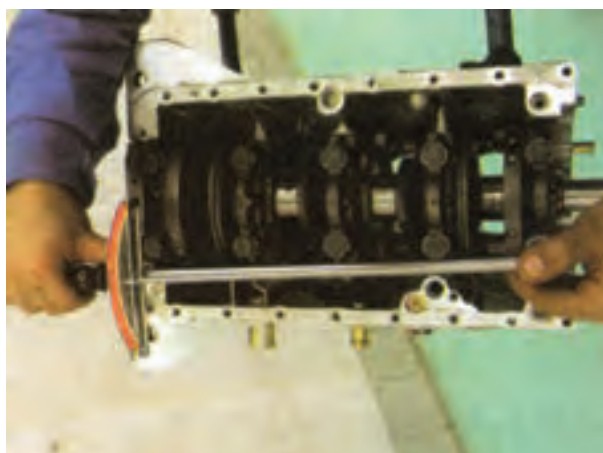
شکل ۱۹۱-۴ - کشیدن پیچ‌های یاتاقان‌های ثابت با گشتاور مناسب
