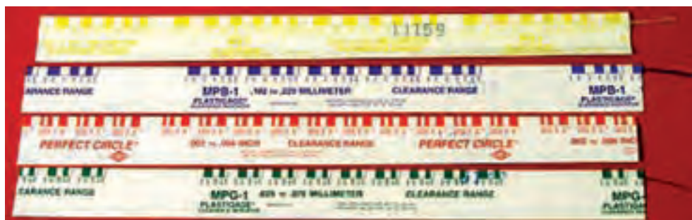
شکل ۱۷۸-۴- انواع پلاستیک گیج
