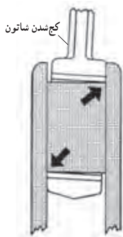
شکل ۱۶۹-۴ وضعیت ساییدگی یاتاقان به دلیل کج قرار گرفتن شاتون روی محور میل‌لنگ
