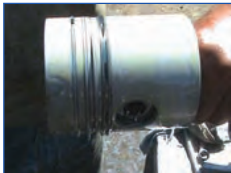
شکل ۱۹۲-۴- روغن‌کاری رینگ‌ها، پیستون و یاتاقان
