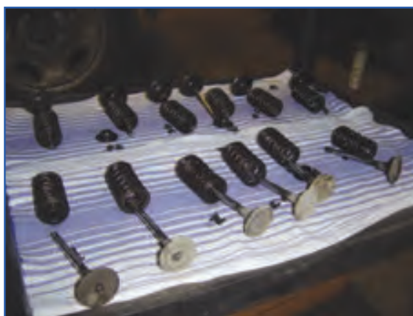
(الف) اجزای باز شده سوپاپ
