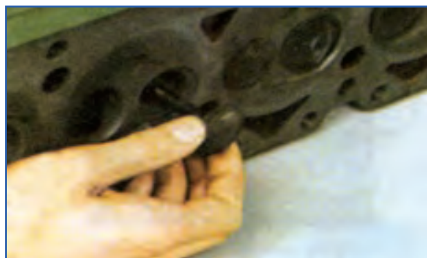
شکل ۲۳-۴- نحوه خارج کردن سوپاپ‌ها
