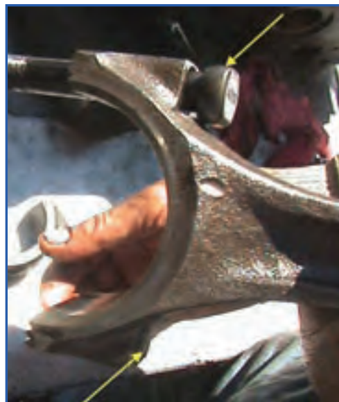
شکل ۸۵-۴- خارج کردن پیچ شاتون
