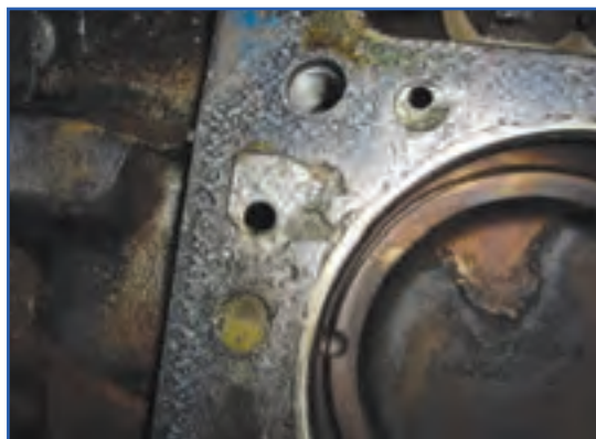
شکل ۴۲-۴ واشر سرسیلندر چسبیده به سیلندر
