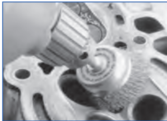
شکل ۴۱-۴ تمیز کردن اتاق احتراق
