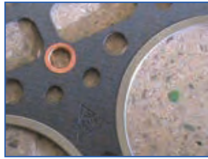
الف) سمت پهن نوار فلزی واشر سرسیلندر
