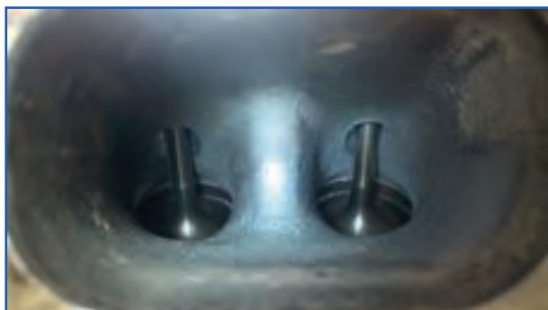
ب) محفظه تمیز پشت سوپاپ‌ها
