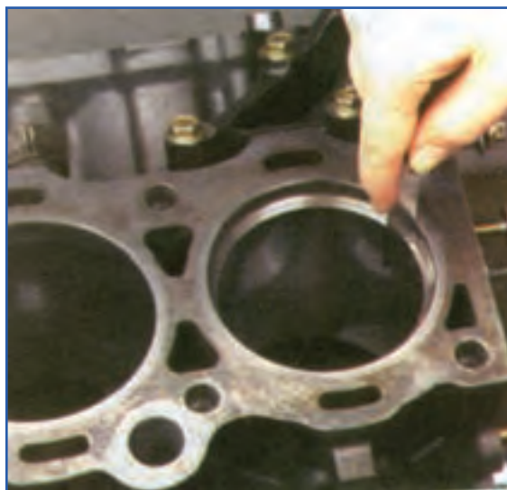
شکل ۱۲۸-۴- طرز اندازه‌گیری دهانه رینگ با فیلر
