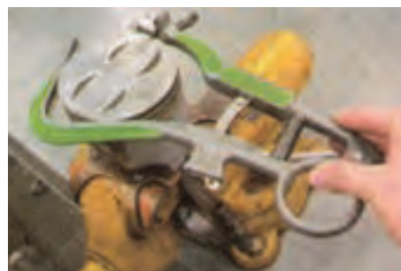
(ب) کاربرد ابزار تمیزکننده شیپار رینگ‌ها
