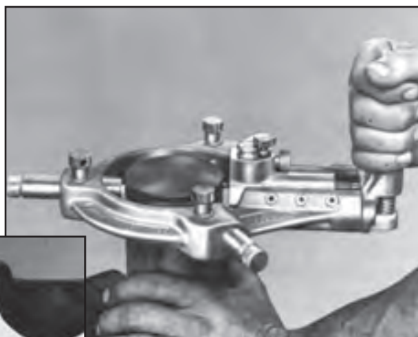
شکل ۹۴-۴- طرز تراش شیار رینگ
