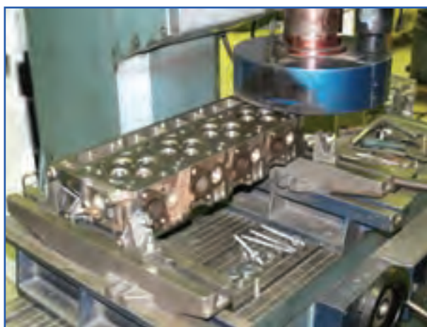
شکل ۳۲-۴- دستگاه کف تراشی سرسیلندر
