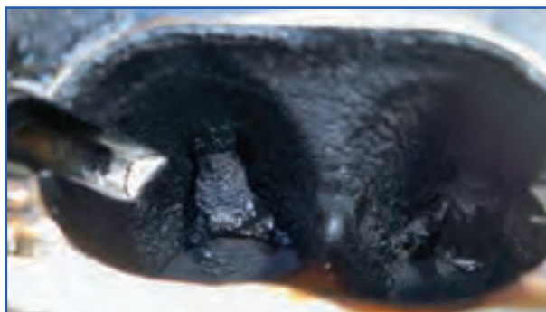
الف) کربن محفظه پشت سوپاپ‌ها
