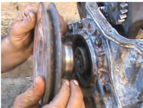
شکل ۴-۵۷- خارج کردن پولی میل لنگ
