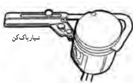
(الف) ابزار تمیزکننده شیپار رینگ‌ها
