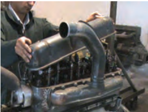
شکل ۴-۷- برداشتن درپوش سوپاپ
