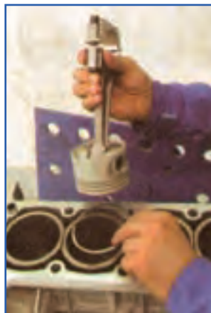
شکل ۱۲۷-۴- طرز قرار دادن رینگ داخل سیلندر
