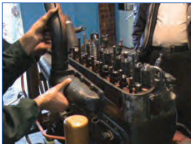
شکل ۴-۴- باز کردن مانیفولد هوا
