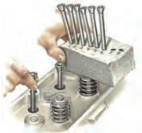
ب) به ترتیب قرار دادن میل تایپت
