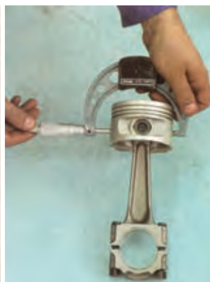
(الف) اندازه‌گیری قطر دامن پیستون
