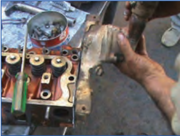
ب) باز کردن محافظه ترموستات تراکتور MF399
