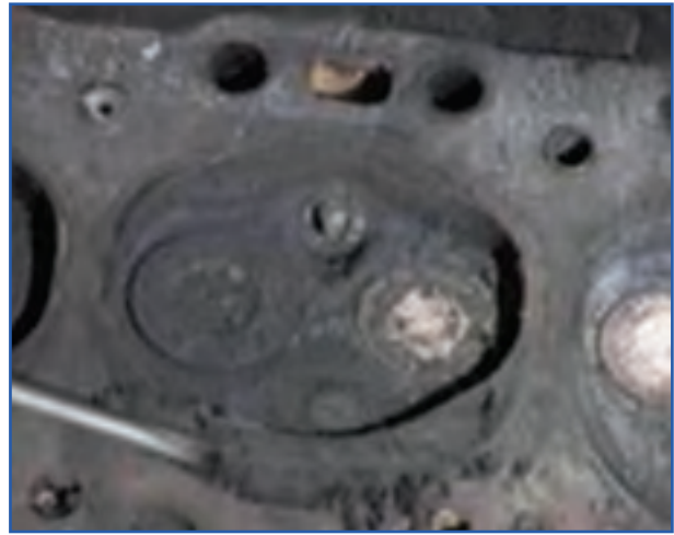
الف) کربن گرفتن سرسیلندر
