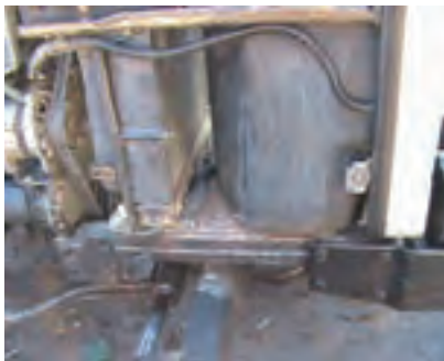
و) باز کردن بست نگه‌دارنده باک
