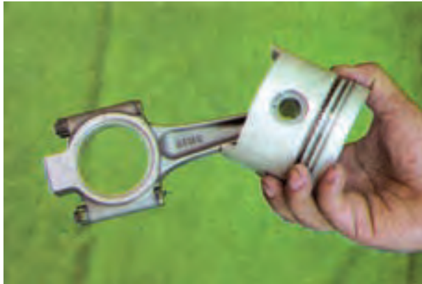
شکل ۱۲۶-۴- طرز آزمایش لقی شاتون روی انگشتی
