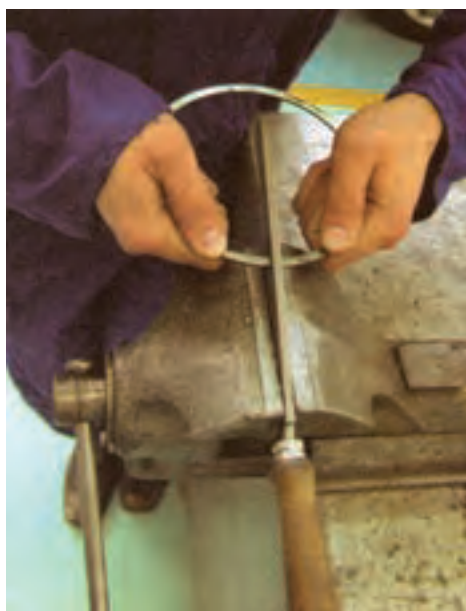
شکل ۱۳۰-۴- ساییدن دهانه رینگ با سوهان
