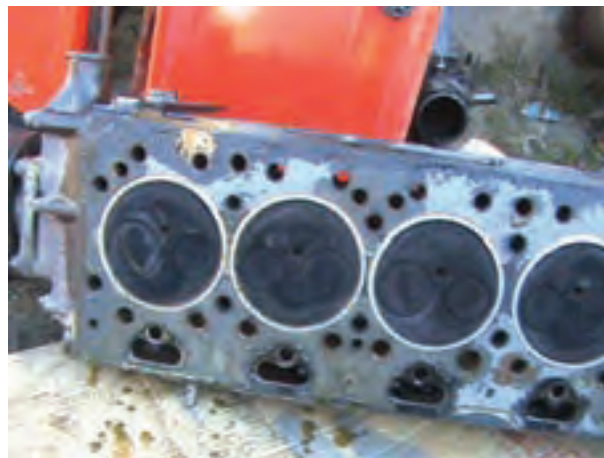
شکل ۱۵-۴- طرز قرار دادن سرسیلندر روی سطح صاف
