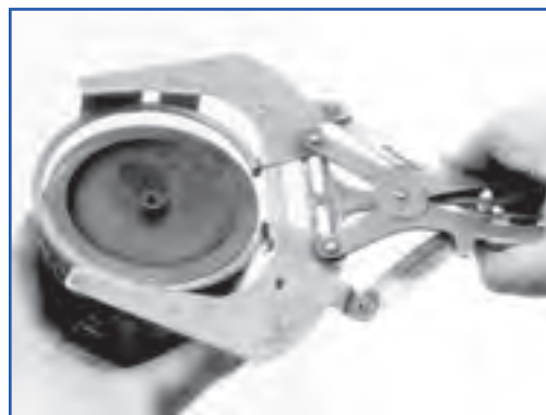
ب) طرز قرار گرفتن رینگ باز کن روی رینگ
