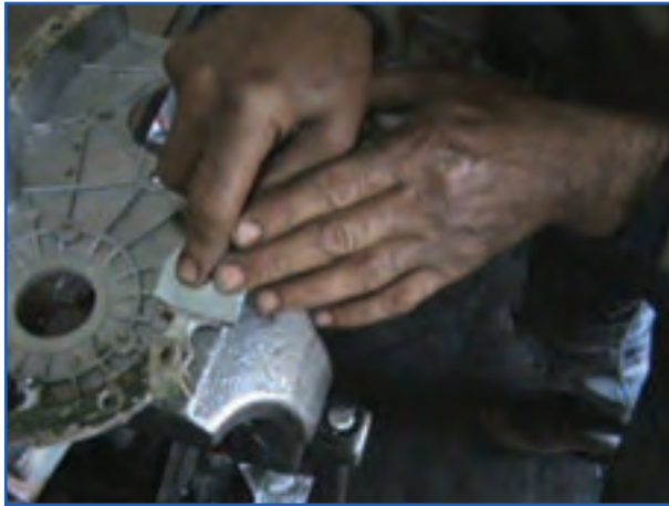
شکل ۷۶-۴- تمیز کردن واشر محفظه جلو موتور
