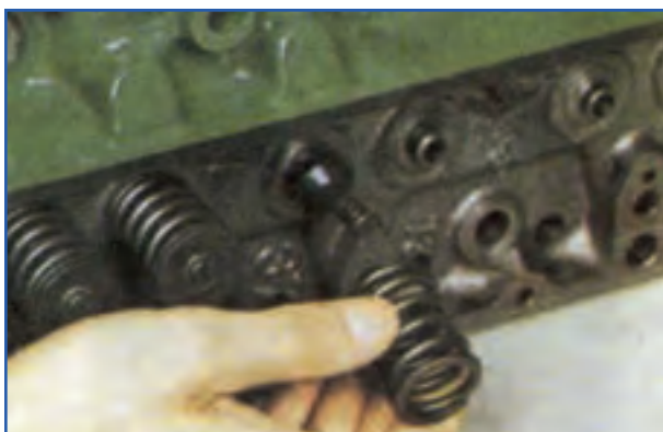
شکل ۲۱-۴- نحوه برداشتن فنر سوپاپ
