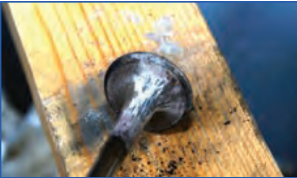
(ب) سوپاپ تمیز شده با کاردک
