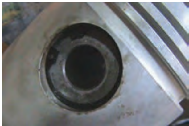
شکل ۱۲۵-۴- جا افتادن خار انگشتی در شیار پیستون
