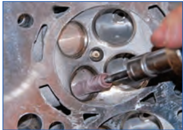
الف) نحوه تمیز کردن محفظه پشت سوپاپ
