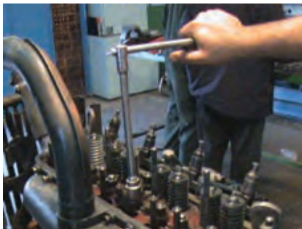
الف) باز کردن پیچ‌های سرسیلندر تراکتور U650
