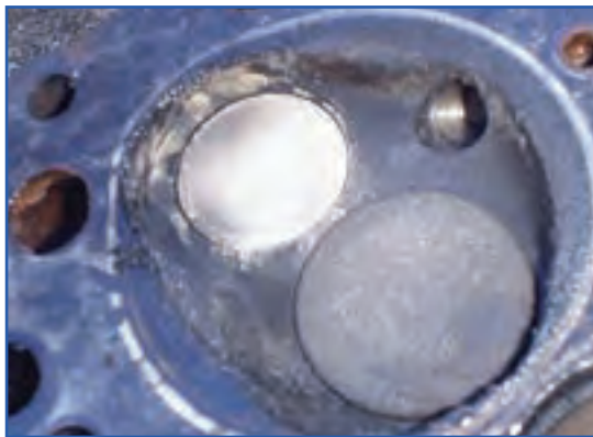
شکل ۴۱-۴ تمیز کردن اتاق احتراق
