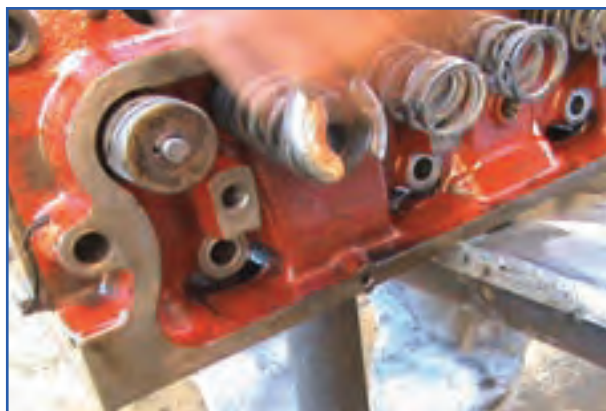
شکل ۱۹-۴- باز کردن اهرم فنر جمع کن
