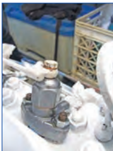
شکل ۵۴-۴- مراحل بستن انژکتور
