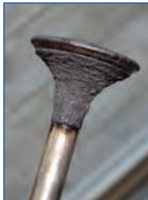
شکل ۴۵-۴- کربن گرفتن بشقابک سوپاپ
