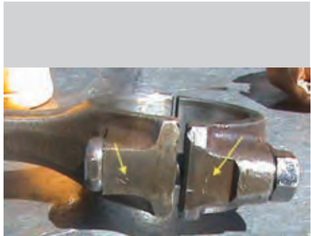
شکل ۸۷-۴- علامت روی کپه شاتون و شاتون
