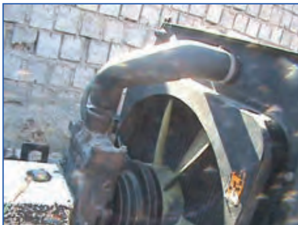
الف) باز کردن لوله لاستیکی رادیاتور
