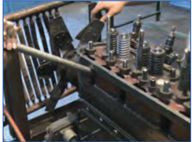
شکل ۱۳-۴- قرار دادن اهرم در مجرای دود
