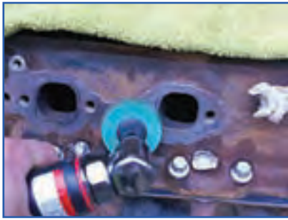
ج) نحوه تمیز کردن سطح مجاری خروج دود
