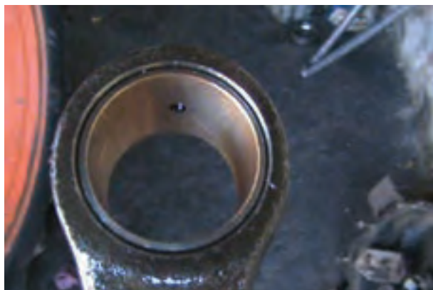
شکل ۱۲۰-۴ قرار گرفتن سوراخ بوش مقابل سوراخ شاتون
