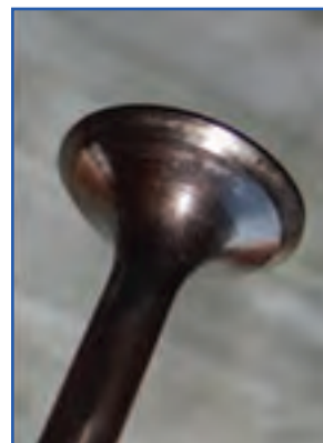
شکل ۴۵-۴- کربن گرفتن بشقابک سوپاپ
