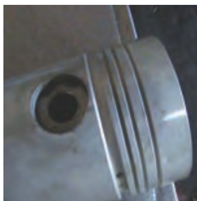
شکل ۱۲۳-۴ میزان داخل شدن انگشتی در پیستون
