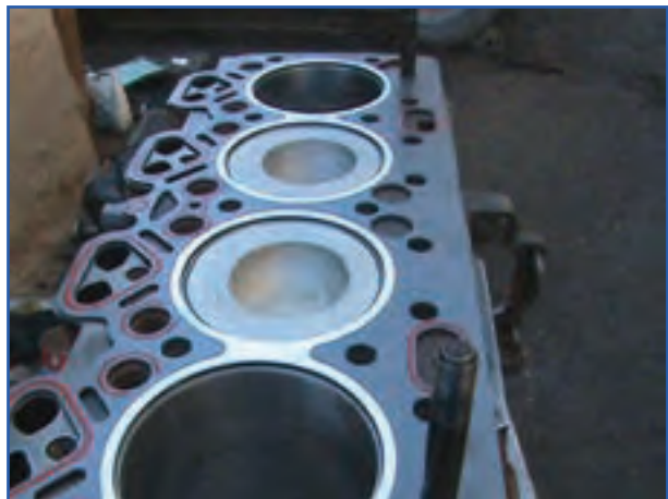
شکل ۵۲-۴- قرار دادن واشر سرسیلندر روی بدنه سیلندر
