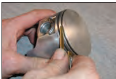
(د) تمیز کردن شیپار با ابزار برنجی
