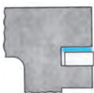
شکل ۹۶-۴- نفوذ کمپرس به شیار رینگ
