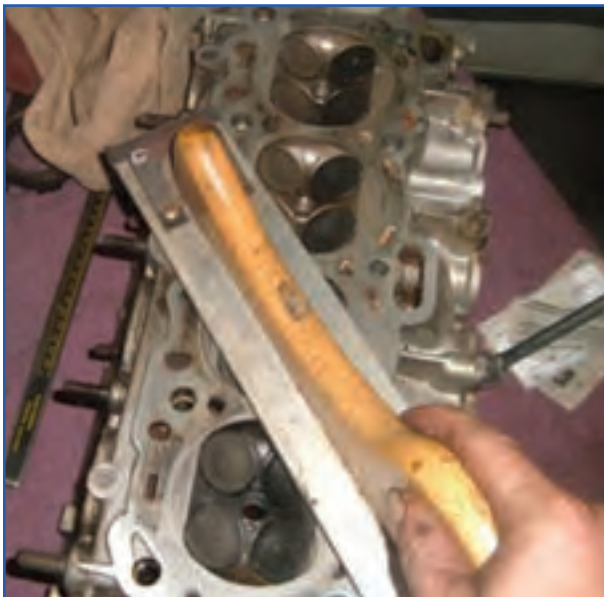
شکل ۴۴-۴- تمیز کردن سرسیلندر با سوهان نرم
