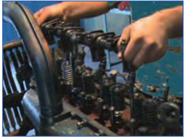
شکل ۹-۴- برداشتن محور اسبک و اسبک‌ها تراکتور U650
