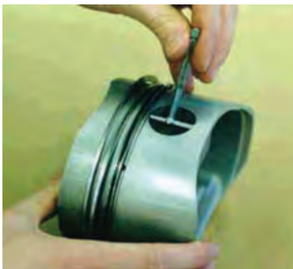
شکل ۱۱۷-۴- اندازه‌گیری سوراخ انگشتی روی پیستون
