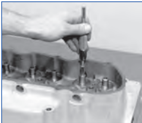
شکل ۴۰-۴ تمیز کردن گیت سوپاپ
