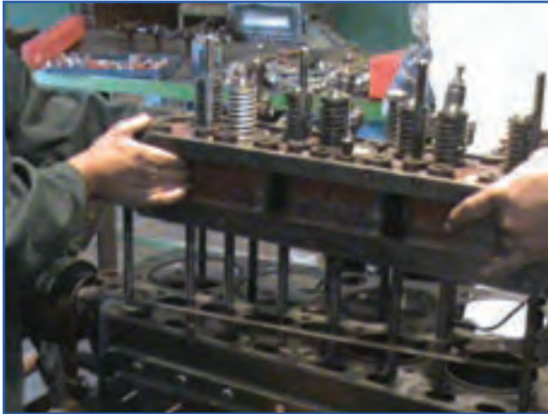
شکل ۱۴-۴- بلند کردن سرسیلندر از روی بدنه سیلندر
