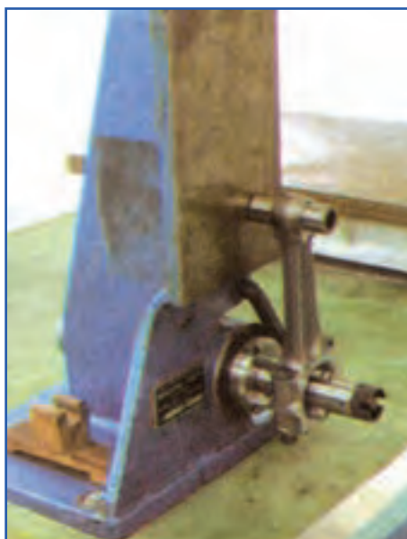
شکل ۱۱۳-۴- ساختمان و طرز نصب شاتون روی فیکسچر
