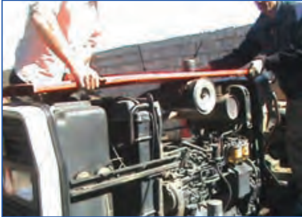
شکل ۱-۴- برداشتن کاپوت از روی موتور
