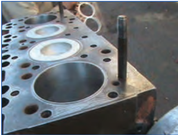
شکل ۵۳-۴- کنترل تمیز بودن سطح سرسیلندر و باز بودن مجاری
