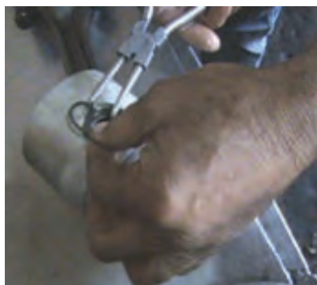
شکل ۱۲۵-۴ طرز جازدن خار انگشتی
