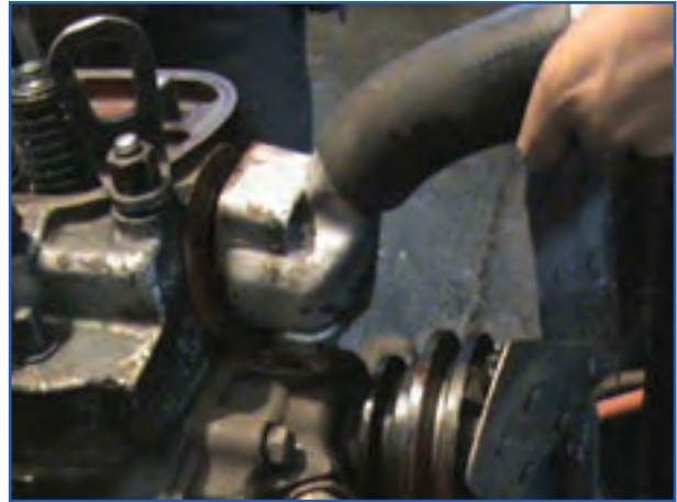
الف) باز کردن محافظه ترموستات تراکتور u650
