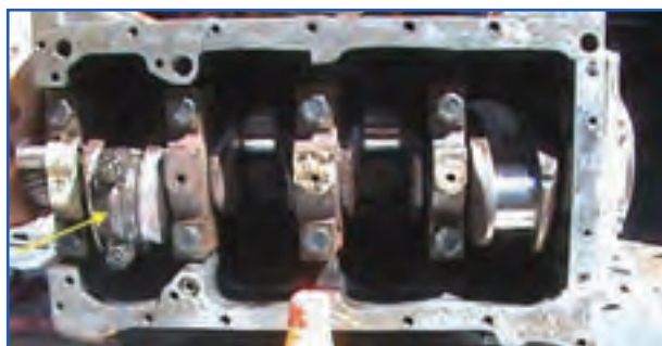
شکل ۸۳-۴- وضعیت میل‌لنگ برای باز کردن پیچ‌های شاتون
