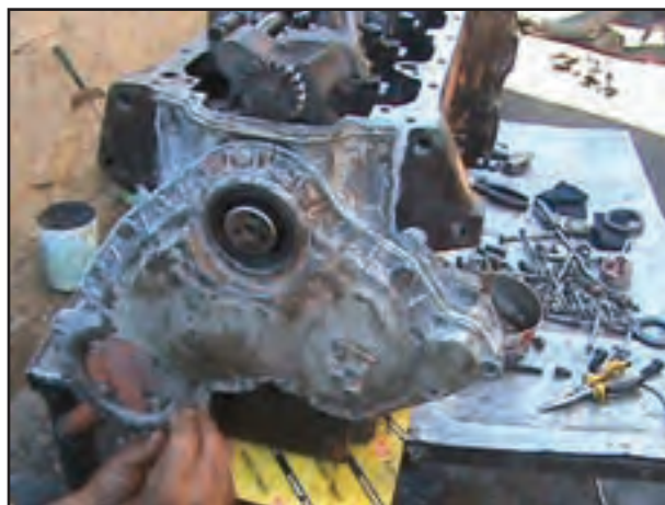
شکل ۴-۵۹- باز کردن پیچ و مهره‌های اطراف سینی جلو
