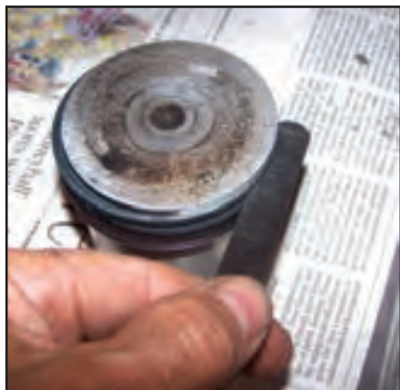
شکل ۹۳-۴- طرز اندازه‌گیری لقی رینگ در شیار رینگ‌ها با فیلر
