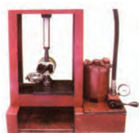
شکل ۱۰۸-۴- خارج کردن انگشتی با پرس هیدرولیک
