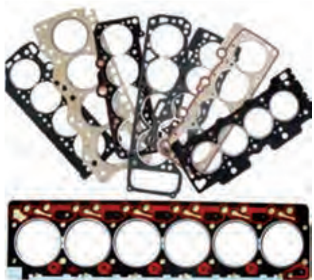
شکل ۶-۲ - چند نوع واشر سرسیلندر
