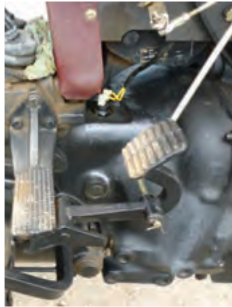
شکل ۱۱-۳- پیچ‌های اتصال موتور به جعبه‌دنده قسمت پایین
