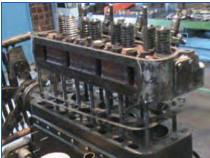
شکل ۵-۲- وضعیت قرار گرفتن واشر سرسیلندر
