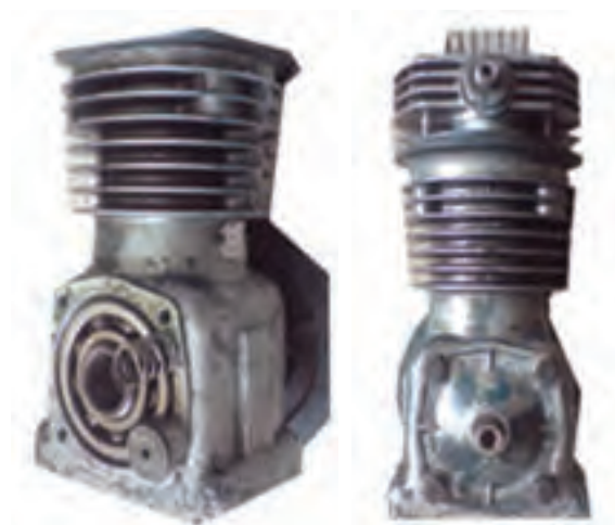
شکل ۴-۸- کمپرسور کامل با بدنه پره‌ای برای خنک شدن
