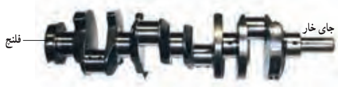
شکل ۳۵-۲ محل فلنج و جای خار روی میل لنگ
