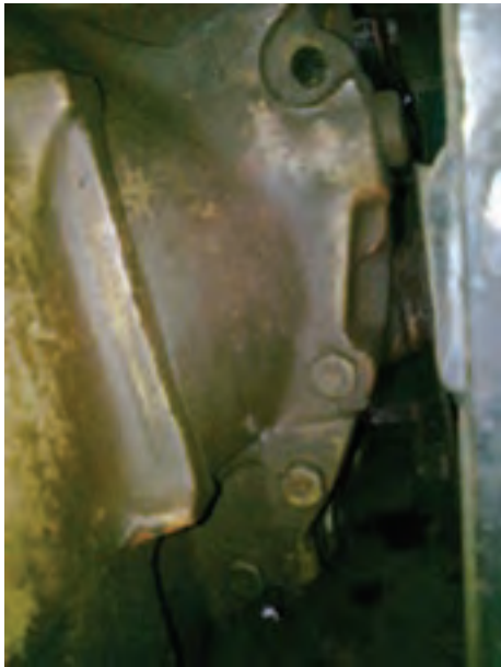
شکل ۱۱-۳- پیچ‌های اتصال موتور به جعبه‌دنده قسمت پایین
