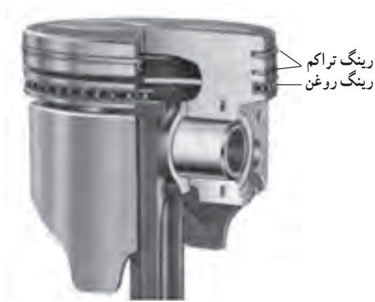
شکل ۲۲-۲- انواع رینگ روی پیستون
