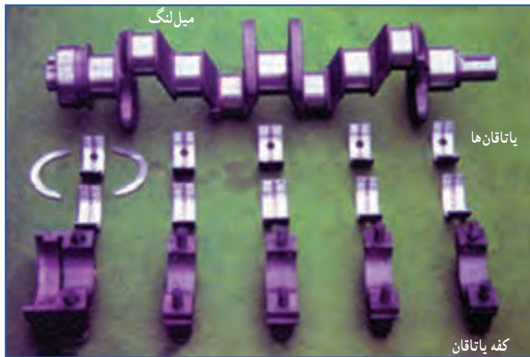
شکل ۳۹-۲- میل‌لنگ، یاتاقان‌ها و کفه یاتاقان‌های ثابت
