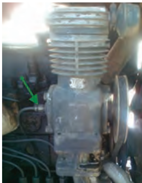
شکل ۵-۸- لوله روغن کاری کمپرسور در تراکتور U650
