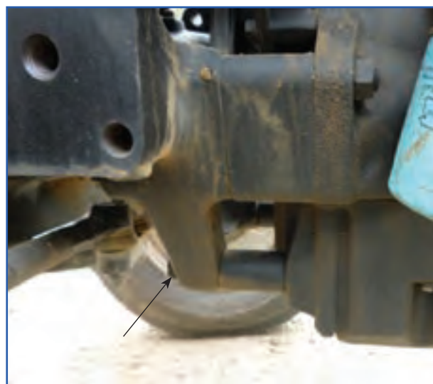
شکل ۱۷-۳- محل پیچ‌های اتصال موتور به جلوی تراکتور
