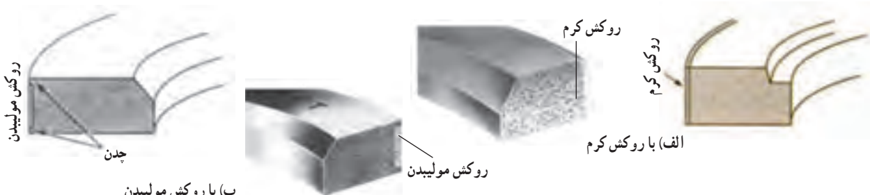
شکل ۲۴-۲- مقطع رینگ‌های تراکم روکش دار
