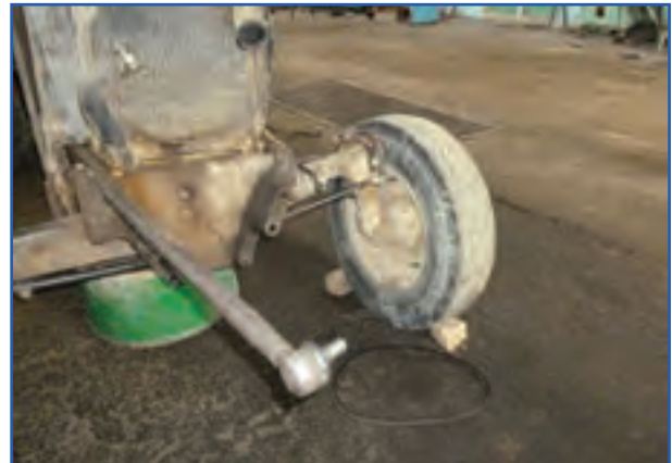
شکل ۱۹-۳- قسمت جلوی تراکتور جدا شده از موتور
