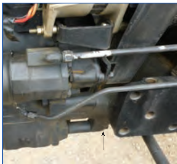
شکل ۱۷-۳- محل پیچ‌های اتصال موتور به جلوی تراکتور
