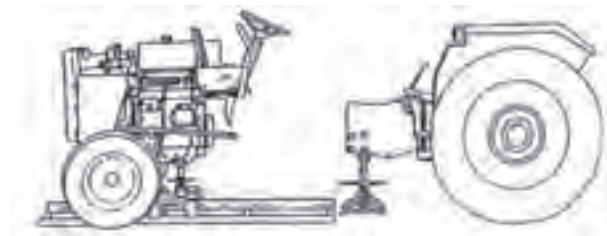
شکل ۱۲-۳- با حرکت جک روی ریل موتور از جعبه‌دنده جدا می‌شود.
