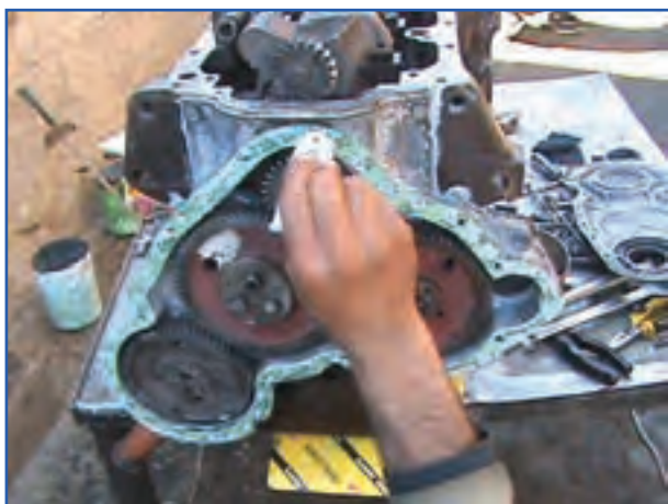
شکل ۴۴-۷- چسب زدن به محل نصب سینی جلو
