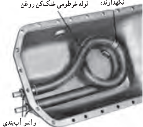
شکل ۳۳-۷- لوله ماریچ آب در کارتر تراکتور جاندیر
