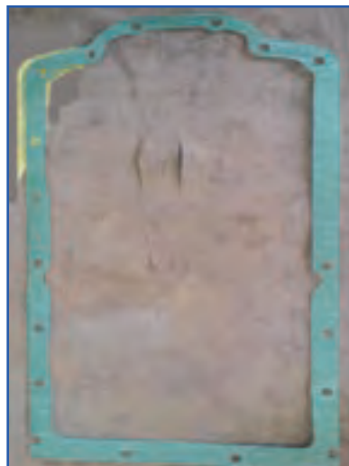
(ب) واشر کارتر چوب‌بنبه‌ای MF285
