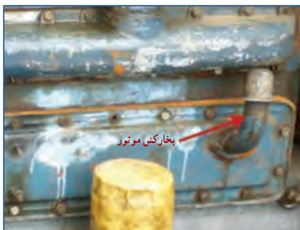
شکل ۲۶-۷- تهویه محفظه کارتور تراکتور U650M
