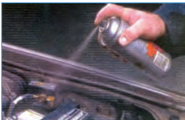
شکل ۱۱-۶- پاشیدن اسپری ضد خوردگی روی بست باتری
