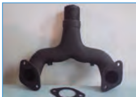
شکل ۲۱-۵- مانیفولد دود تراکتور U650
