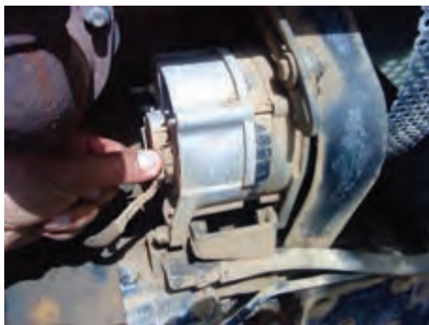
شکل ۲۸-۶- جدا کردن فیش از آلترناتور
