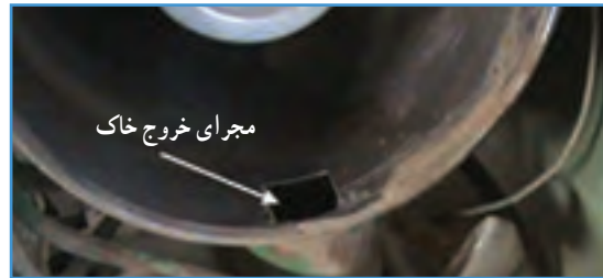
شکل ۱۱-۵ محل خاکدان در تراکتور جاندیر
