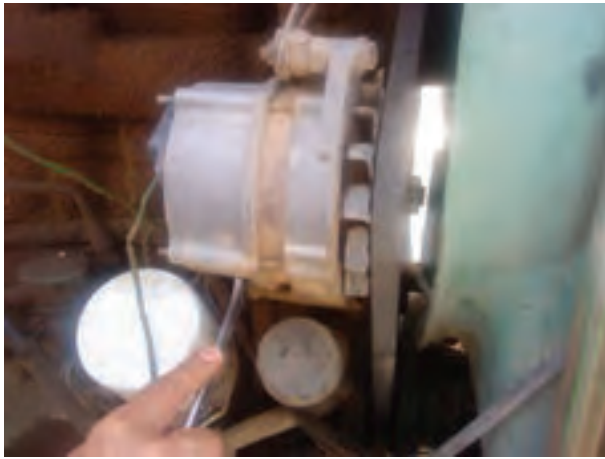
شکل ۳۹-۶ سفت کردن پیچ پایه
