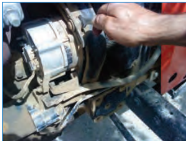
شکل ۲۹-۶ شل کردن پیچ و مهره تنظیم
