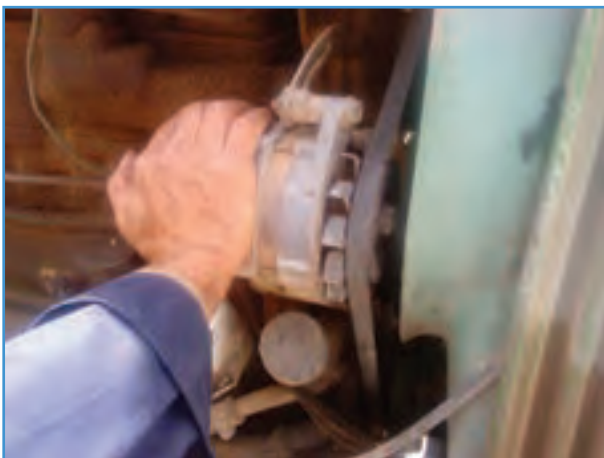
شکل ۳۰-۶ فشار دادن آلترناتور به عقب
