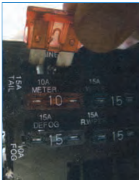
شکل ۶۹-۶- جازدن فیوز در محل آن
