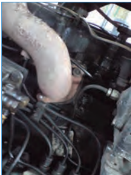
شکل ۳۱-۵- محل اتصال مانیفلد به سرسیلندر تراکتور U650
