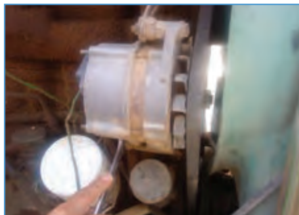
شکل ۳۱-۶ باز کردن پیچ پایه آلترناتور
