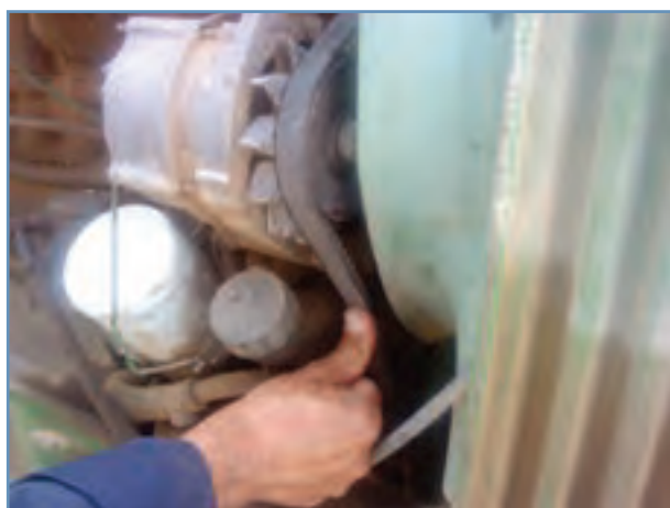
شکل ۳۶-۶ فشار دادن تسمه با شست
