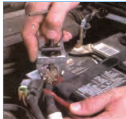
شکل ۸-۶- باز کردن بست مثبت باتری
