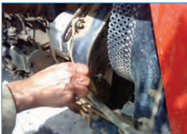
شکل ۳۲-۶ باز کردن روکش محافظ تسمه
