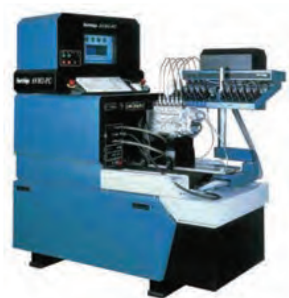
شکل ۲۴- دستگاه آزمودن و تنظیم پمپ انژکتور
