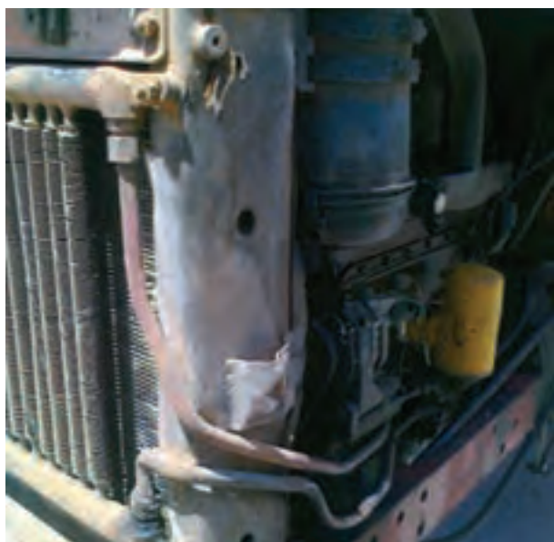
شکل ۱۲-۳- محل مهره‌های رادیاتور روغن
