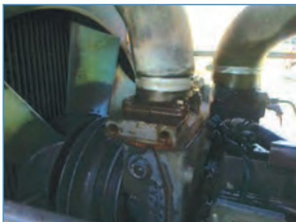
شکل ۱۱-۳- محل بست شیلنگ محفظه ترموستات
