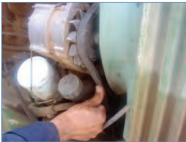
شکل ۲۸-۳ اندازه‌گیری کشش تسمه با فشار انگشت
