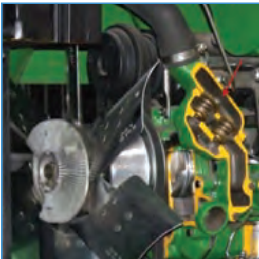
شکل ۲۴-۳ - طرز صحیح قرار گرفتن ترموستات
