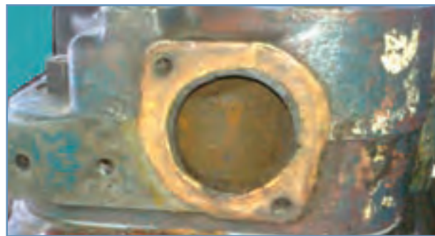
شکل ۲۳-۳ - واشر ترموستات قبلی
