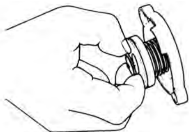
شکل ۱۷-۳- آزمون سوپاپ مکش در رادیاتور
