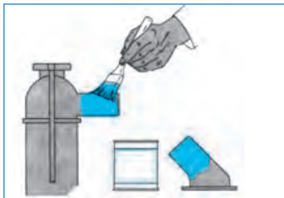
الف) جرب کردن لوله های رادیاتور
