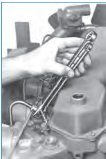
شکل ۲۲-۴ باز کردن لوله‌های فشارقوی انژکتورها
