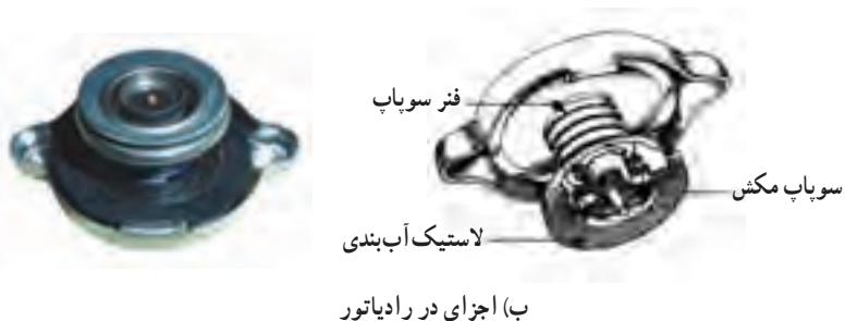
شکل ۳-۵- در رادیاتور و طرز کار سوپاپ‌های آن
