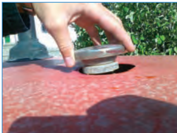
شکل ۷-۳- باز کردن در رادیاتور تراکتور MF285
