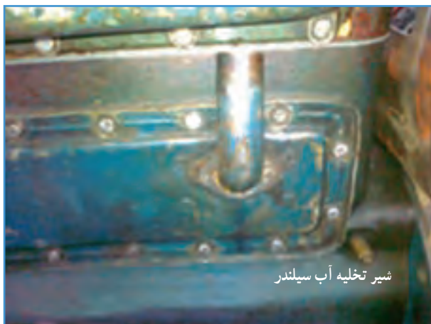
شکل ۸-۳- شیر تخلیه آب سیلندر تراکتور U650
