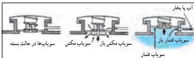
الف) وضعیت سوپاپ‌های در رادیاتور
