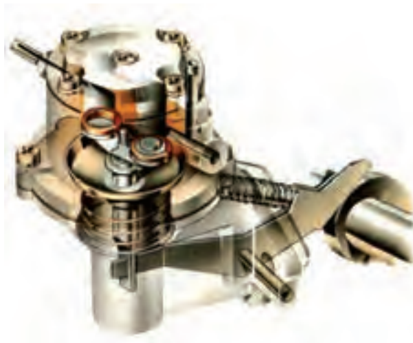
شکل ۷-۴ پمپ مقدماتی دیافرآگمی
