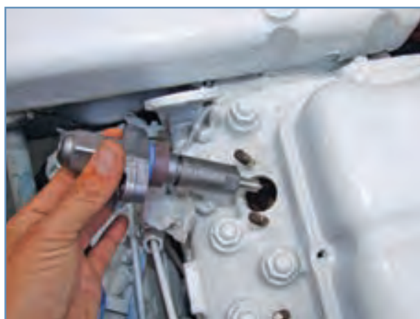
شکل ۲۳-۴ خارج کردن انژکتور
