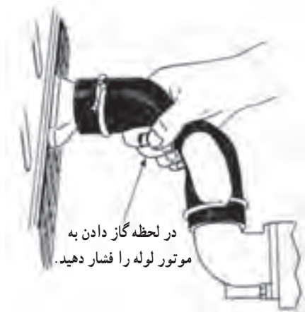
شکل ۲۰-۳ نحوه فشار دادن شیلنگ بالای رادیاتور
