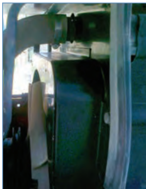
شکل ۳۲-۳. محل بادگیر رادیاتور در تراکتور MF399
