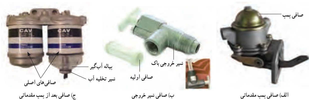
شکل ۹-۴- انواع صافی گازوئیل
