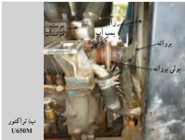
شکل ۳۵-۲- پمپ آب تراکتور
