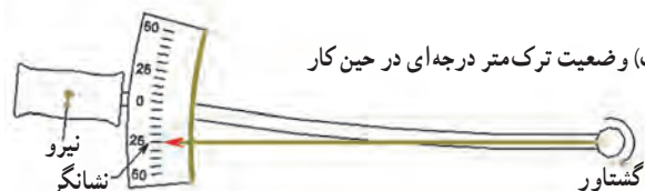
شکل ۳-۵۵- ترک متر درجه‌ای
