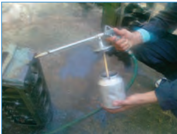
شکل ۱-۳- باز کردن مخزن پیستوله شستشو
