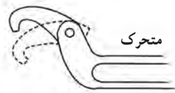
شکل ۵۹-۳- نحوه استفاده از آچار مهره‌ای گرد
