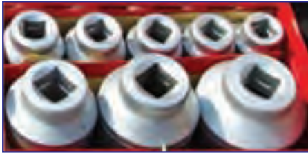
شکل ۳۹-۳- انواع شکاف چهار گوش (درایوبکس) آچار بکس
