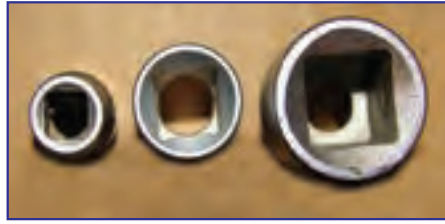
شکل ۳۹-۳- انواع شکاف چهار گوش (درایوبکس) آچار بکس
