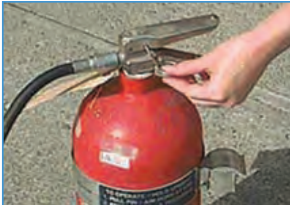
شکل ۱۱-۱- نحوه خارج کردن ضامن کپسول
