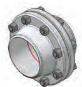
شکل ۳-۱- کاربرد پیچ و مهره برای اتصال
