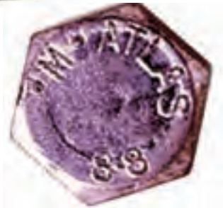
شکل ۱۵-۳ اعداد حک شده روی سر پیچ
