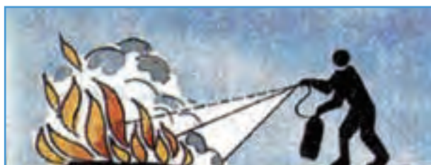
شکل ۱۳-۱- روش خاموش کردن آتش با پودر
