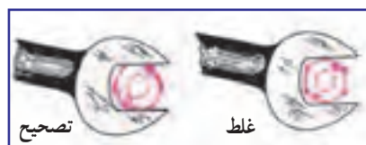
شکل ۲۹-۳ طرز درگیر کردن آچار تخت با مهره
