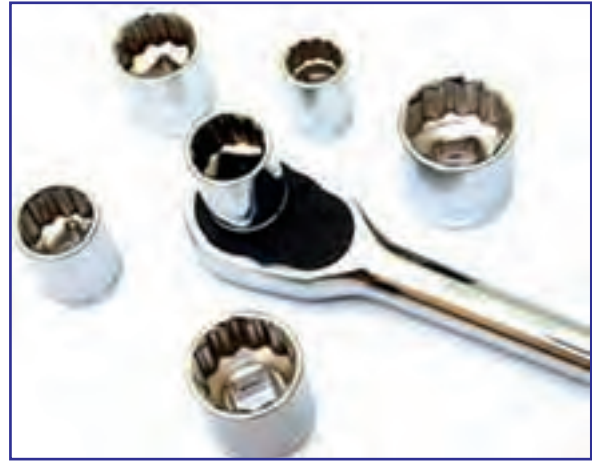
شکل ۴۸-۳- اتصال بکس به دسته بکس جفجغه ای
