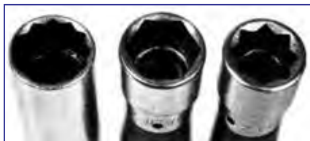
شکل ۳۵-۳- آچار بکس شش، هشت و دوازده گوش
