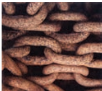
زنگ‌زدن یک زنجیر آهنی
