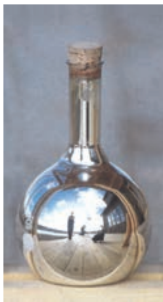
تشکیل آینه نقره‌ای هنگام اکسایش متانال
