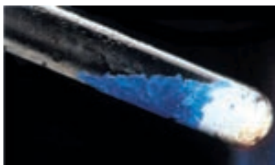
الف) تبدیل مس (II) سولفات پنج آبه به مس (II) سولفات خشک
