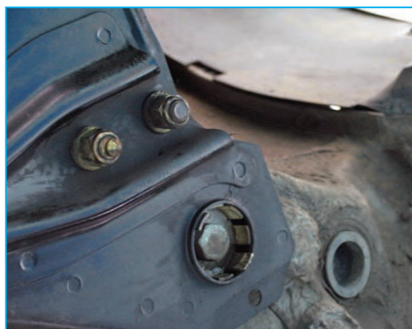
شکل ۳-۱۲۲- باز کردن پیچ های طبق
