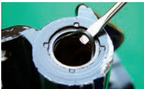
شکل ۶۵-۲- تعویض لاستیک
