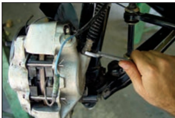
شکل ۱-۱۱۹- باز کردن شیلنگ ترمز
