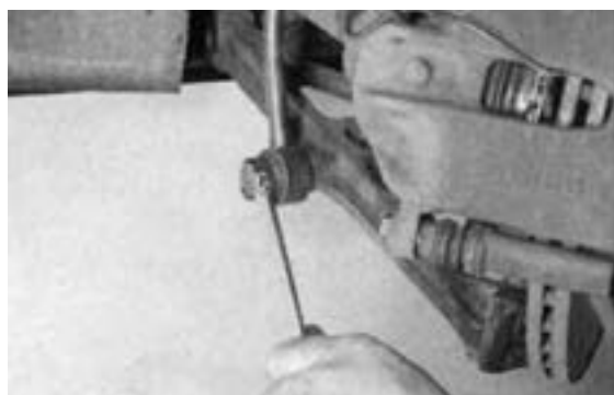
شکل ۱۲۰-۳- باز کردن میل موج گیر کوتاه به طبق
