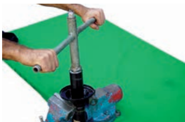
شکل ۳-۹۱- باز کردن مهره نگه‌دارنده کمک فنر
