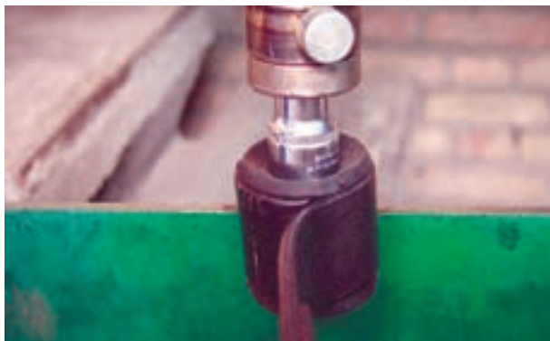
شکل ۳-۶۹- بوش لاستیکی فلزی محل اتصال شاه فنر
