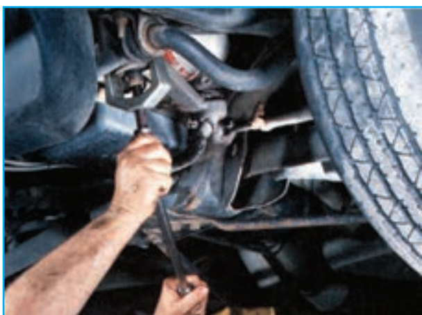
شکل ۴۷-۲- نحوه استفاده از نوعی سیبک کش
