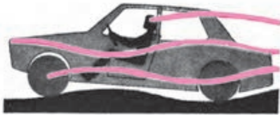
خودروی بدون ضربه گیر خودرو، در هر ناهمواری بالا و پایین می رود و دائماً نوسان می کند.
