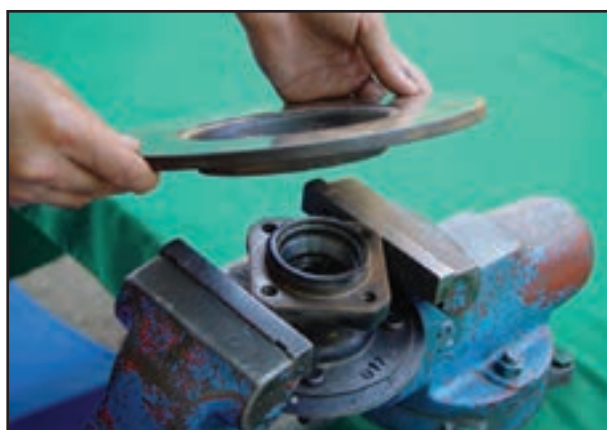
شکل ۱۲۶-۱ بازکردن دیسک ترمز
