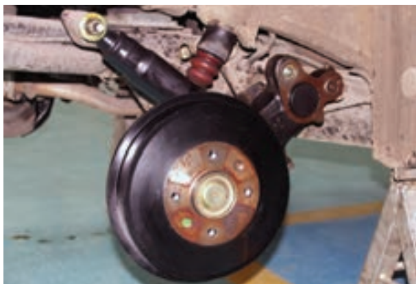
شکل ۱۷۷-۳- نصب کمک فنر
