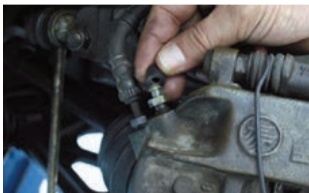
شکل ۱-۷۰- پاک کردن اطراف پیچ هواگیری
