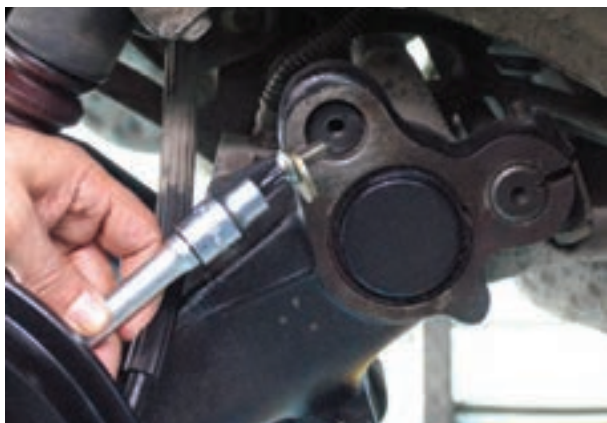
شکل ۱۷۶-۳- نصب واشر فشار و پیچ‌های انتهای میله‌ها
