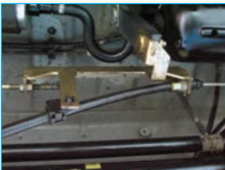
شکل ۱-۵۴- کابل های ترمز دستی
