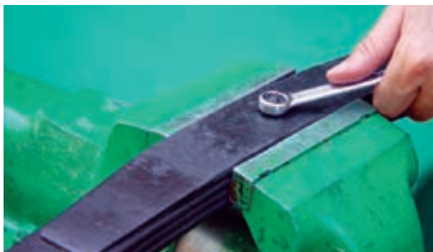
شکل ۳-۶۸- باز کردن پیچ مرکز فنرهای شمش
