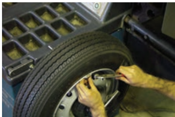
شکل ۲۳۸-۳ نصب وزنه روی قسمت بیرونی رینگ
