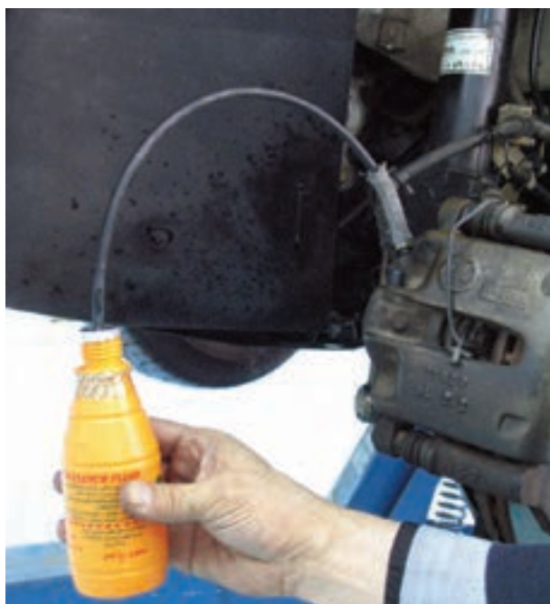
شکل ۱-۷۱- نصب لوله پلاستیکی روی پیچ هواگیری
