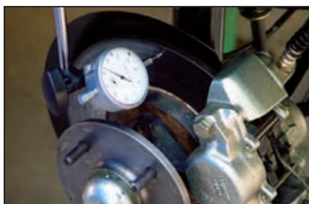
شکل ۱-۱۲۳- بررسی وضعیت دیسک
