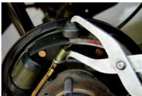
شکل ۱-۱۰۷- جازدن فنر بالایی کفشک
