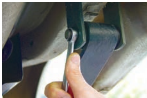
شکل ۳-۶۵ – باز کردن مهره‌های گوشواره فنر شمش
