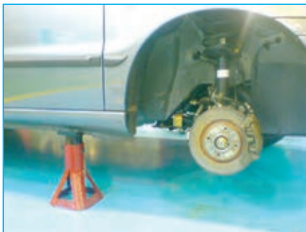
شکل ۳-۶۱- خودروی مستقر بر پایه قابل تنظیم
