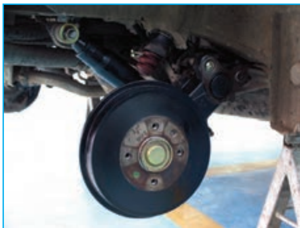
شکل ۱۸۳-۳- نصب ژامبون و متعلقات چرخ عقب
