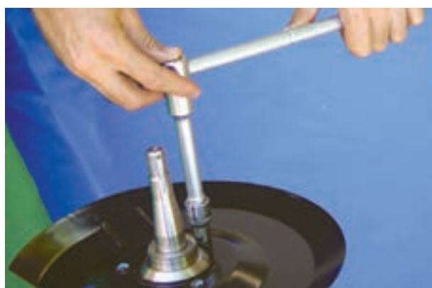
شکل ۳-۹۶- باز کردن صفحه پشت توپی چرخ
