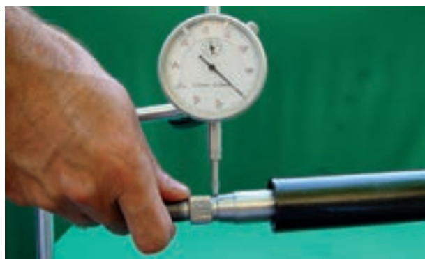
شکل ۶۹-۲ اندازه‌گیری لقی جانبی میل فرمان
