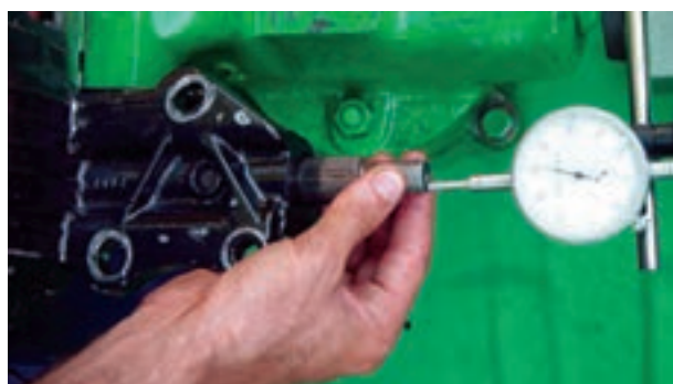
شکل ۷۰-۲ اندازه‌گیری لقی طول محور هزار خار
