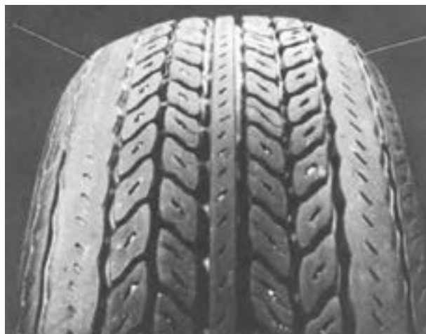
شکل ۲۱۴-۳- ساییش در اثر رانندگی غلط (پیچیدن تند)
