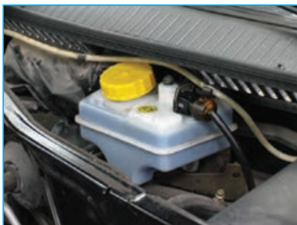
شکل ۱-۱۲۸- اتصال حسگر اخطار دهنده کم بودن مایع ترمز در مخزن
