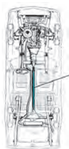
شکل ۲۸۹ - موقعیت میل گاردان در سیستم انتقال قدرت
