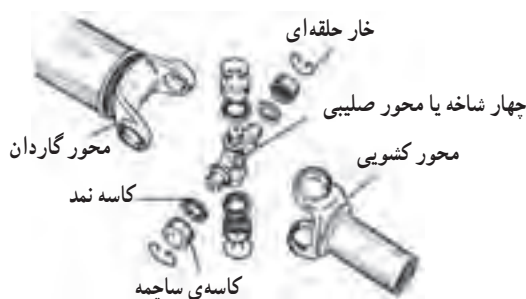
شکل ۲۹۱- اجزای قفل گاردان
