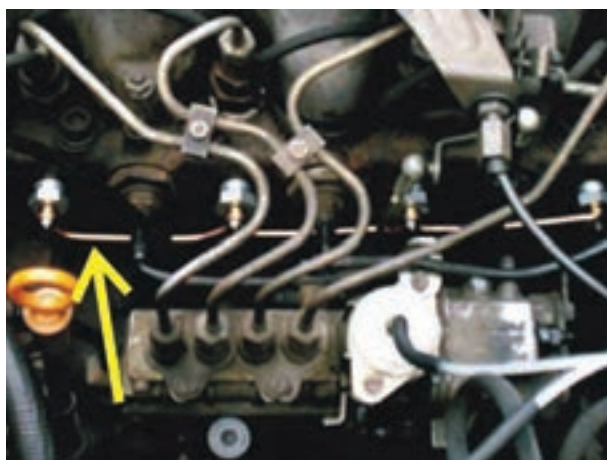
شکل ۷-۱۳- اتصال سری شمع گرم کن
