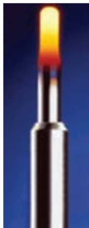
شکل ۳-۱۳- شمع گرم کن در حالت گداخته بودن
