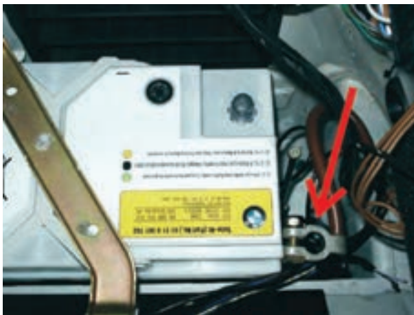
شکل ۹-۱۱- باز کردن کابل اتصال بدنه ی باتری
