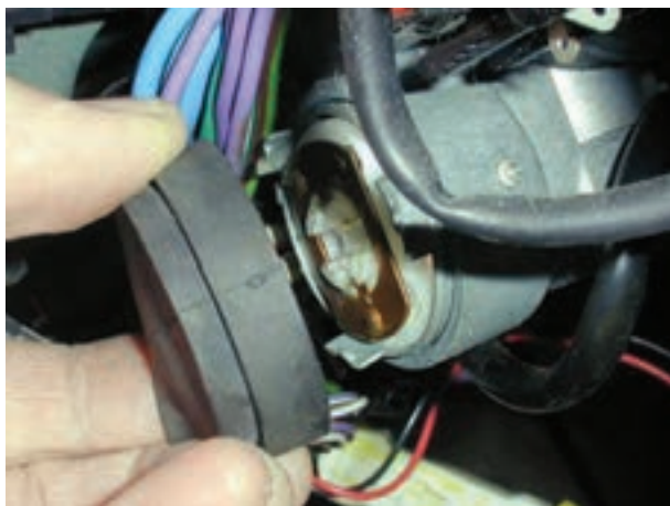
شکل ۱۱-۱۳- بیرون آوردن فیبری پشت سوئیچ
