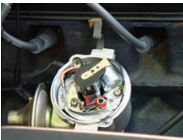
شکل ۵۵-۱۰- راستای چکش برق به سمت سیلندر یک
