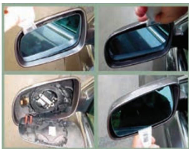
شکل ۱۶۷-۲- بیرون آوردن آینه از داخل قاب آن
