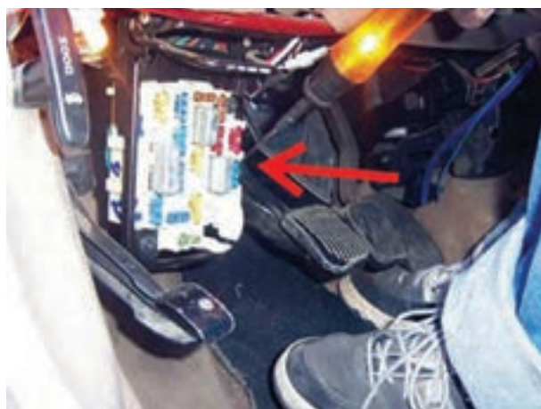
شکل ۱۸۹-۲- آزمایش پایه‌های فیوز
