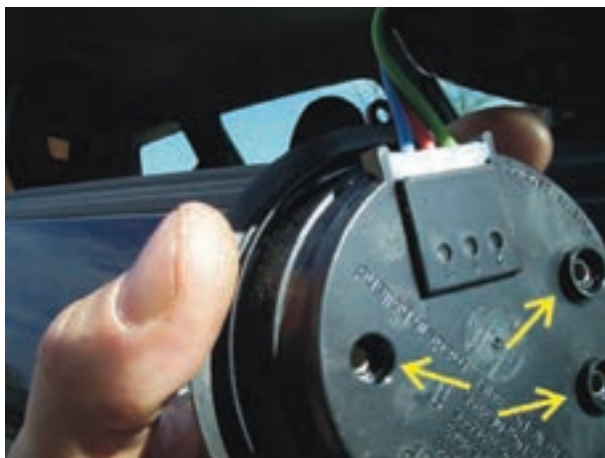
شکل ۱۷۲-۲- جدا کردن محفظه‌ی موتورهای الکتریکی
