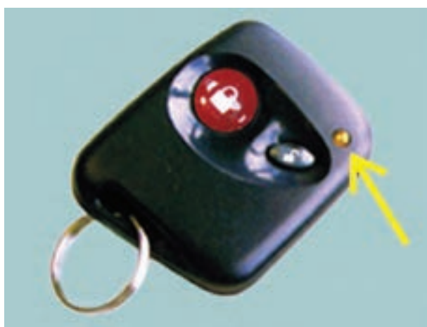
شکل ۲-۷- دیود نوری روی قاب ریموت کنترل
