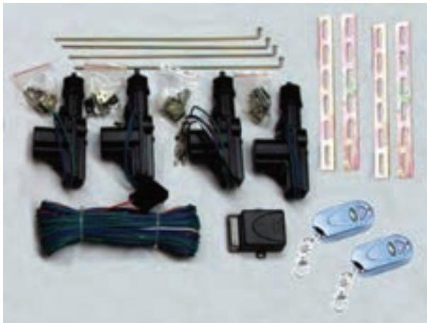
شکل ۲-۴- قطعات مدار الکتریکی قفل مرکزی
