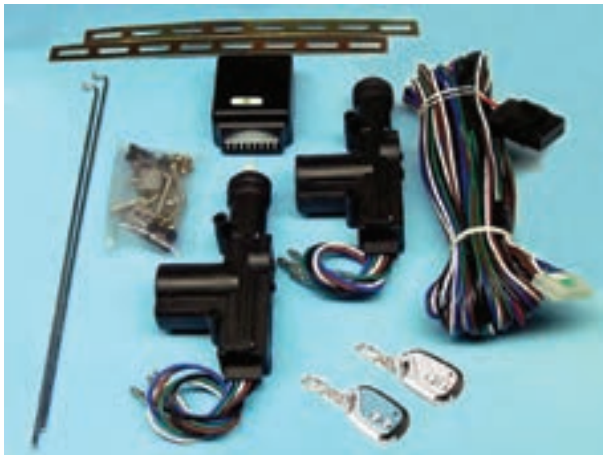
شکل ۱-۲- اجزای مدار قفل مرکزی
