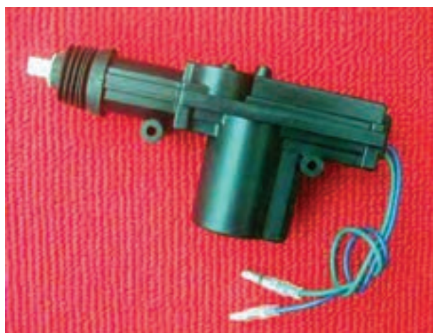
شکل ۲-۸- یک نوع عملگر سیستم قفل مرکزی
