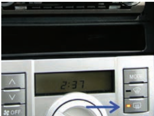
شکل ۳-۱۷- سوئیچ شیشه گرم‌کن در حالت (on)
