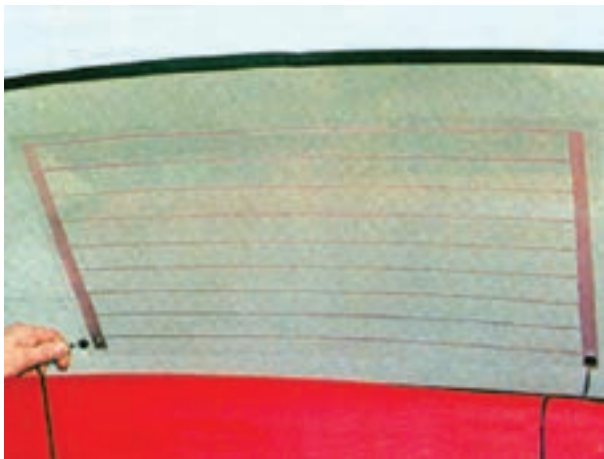
شکل ۱۰-۳- برقراری اتصالات الکتریکی
