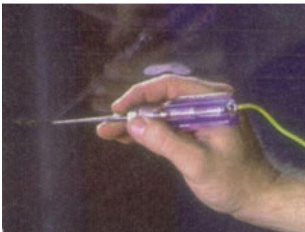
شکل ۲۹-۳- آزمایش و بررسی مدار قطع شده‌ی المنت حرارتی
