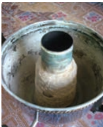
شکل ۸-۵- تشکیل رسوب در سماور و لوله‌ها
