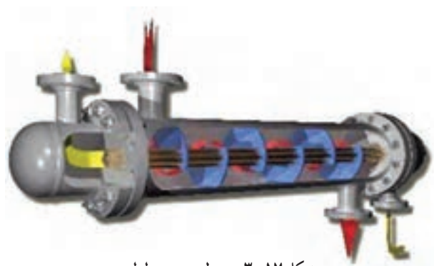
شکل ۳-۱۷ مبدل پوسته و لوله
