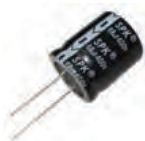
شکل ۴۶-۱ تصویری از یک خازن که روی آن ظرفیت و اختلاف پتانسیل پیشینه قابل تحمل نوشته شده است.
