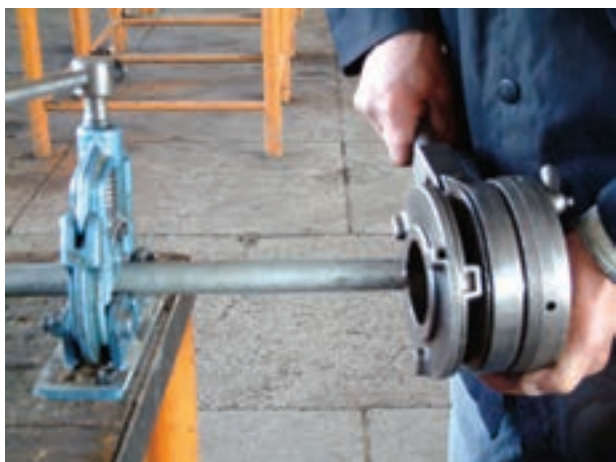
شکل ۵-۱۳۶- حدیده کردن لوله‌ها
