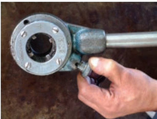
شکل ۴-۴۳- خارج کردن ضامن از شيار
