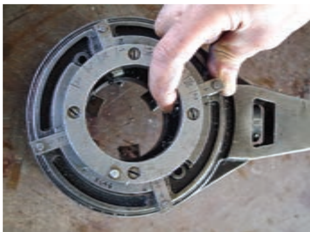
شکل ۴-۶۰- قرار دادن پارچه‌های مناسب در حدیده
