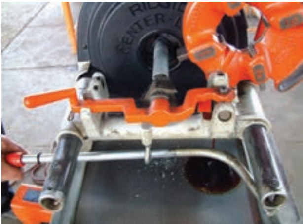
شکل ۱۳۲-۴ عمل بُرقوکاری
