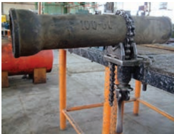
شکل ۱-۳۴- بستن لوله به گیره‌ی زنجیری
