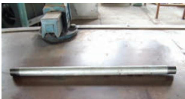
شکل ۴-۶- لوله ی دو سر دنده شده
