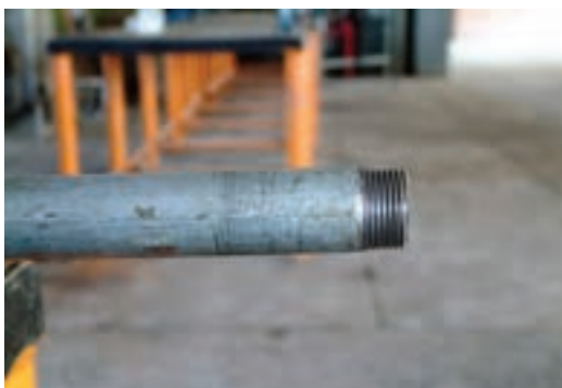
شکل ۴-۵- لوله فولادی گالوانیزه
