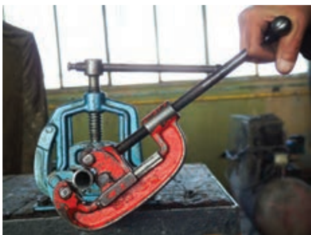
شکل ۱-۵۶ - گرداندن لوله‌بُر به دور لوله
