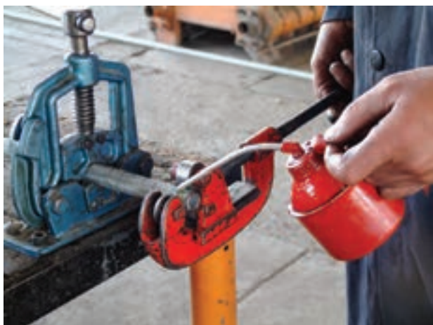
شکل ۱-۵۷ - ریختن روغن در محل تماس
