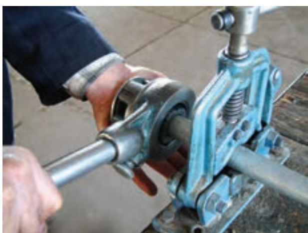
شکل ۴-۴۷- شروع دنده کردن لوله
