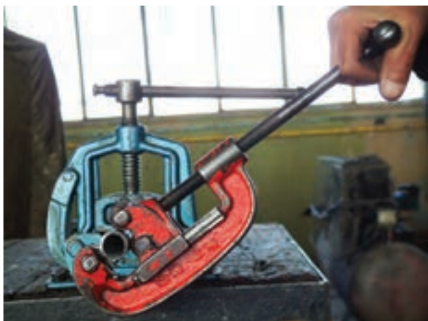
شکل ۱۵۰-۵ بریدن لوله ها
