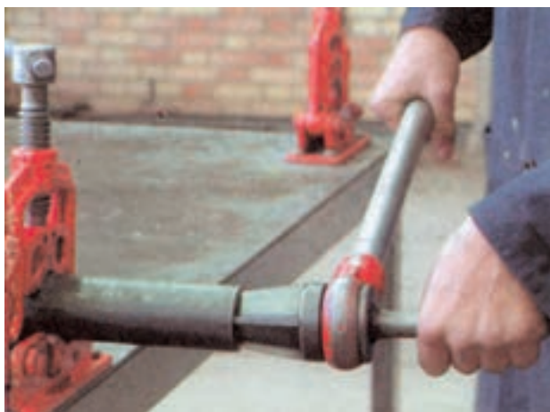
شکل ۱۲-۲- عمل بُرقوکاری
