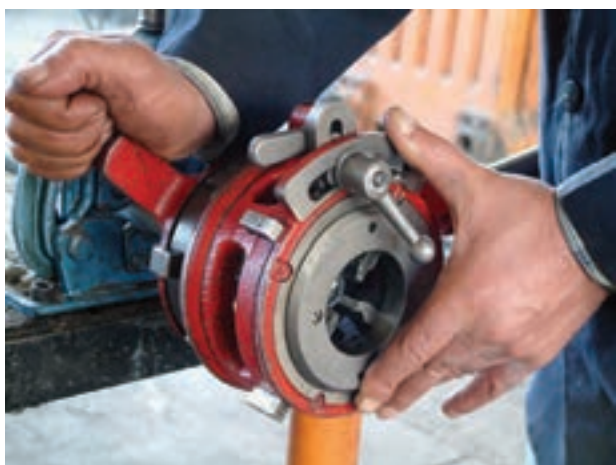
شکل ۴-۱۱۴- سفت کردن فلکه‌ی چهار نظام
