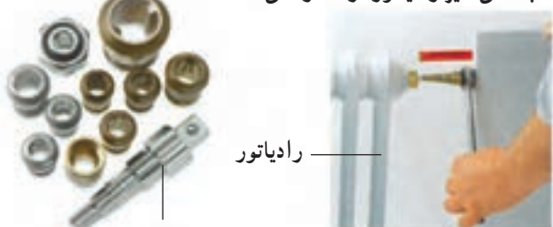
آچار پله‌ای با قطرهای متفاوت
