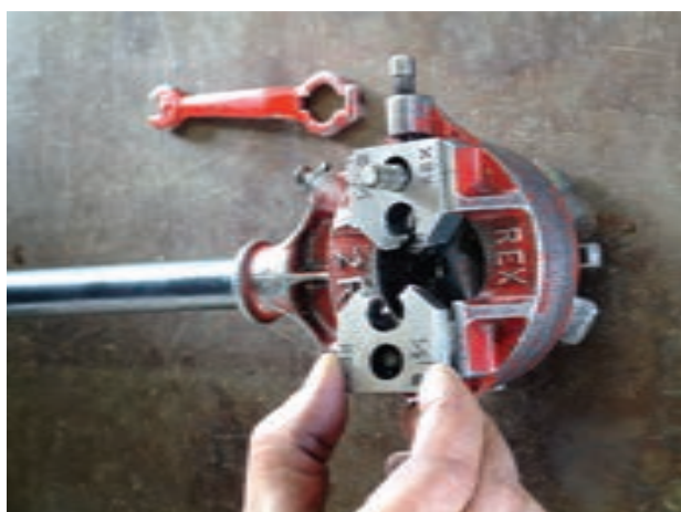
شکل ۴-۲۶ قرار دادن پارچه‌ها در محل خود
