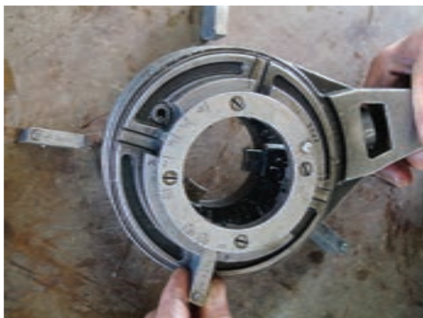
شکل ۴-۵۹- خارج کردن پارچه‌ها از حدیده
