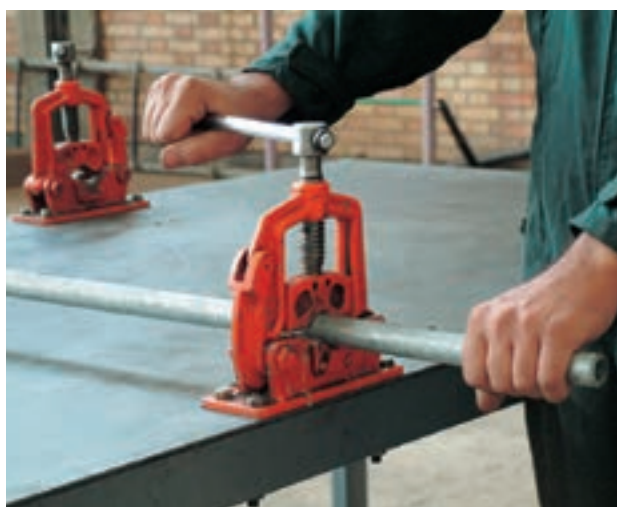
شکل ۱-۲۸ بستن لوله به گیره‌ی لوله
