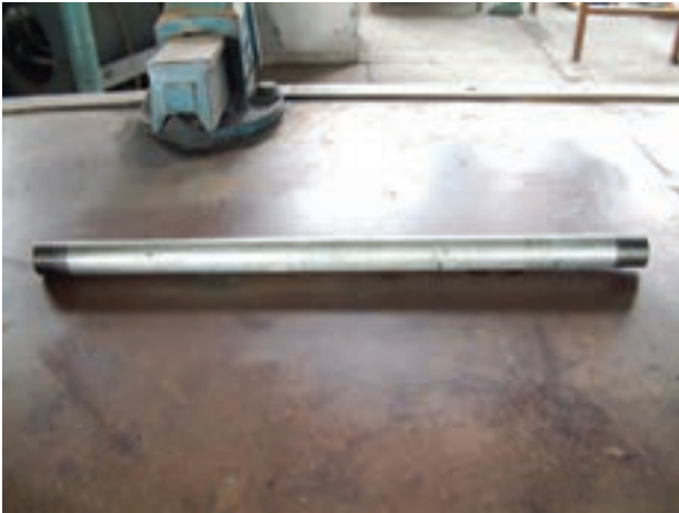
شکل ۴-۱۴۱- لوله‌ی دو سر دنده شده
