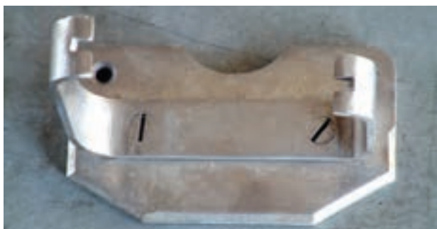
شکل ۴-۵- اتصال موقت با استفاده از پیچ
