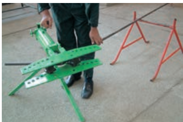
شکل ۳-۴۲- استفاده از خرک در خم کاری
