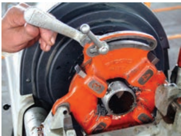
شکل ۴-۷۸- عمل حدیده‌کاری با حدیده‌ی ماشینی
