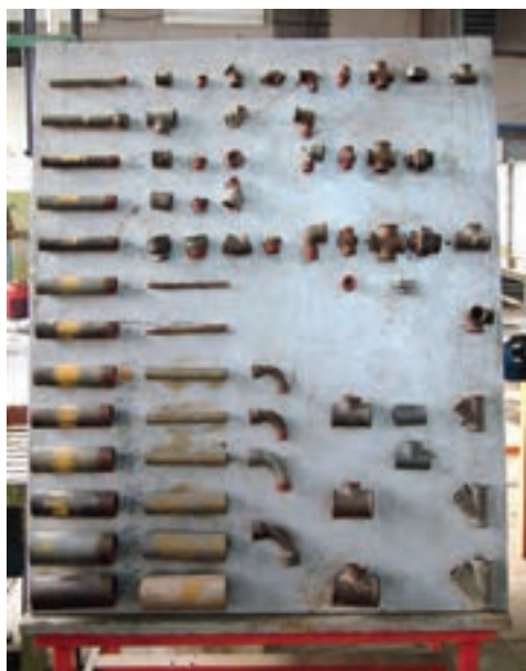
شکل ۳۵-۵- انواع لوله و فیتینگ‌های دنده‌ای
