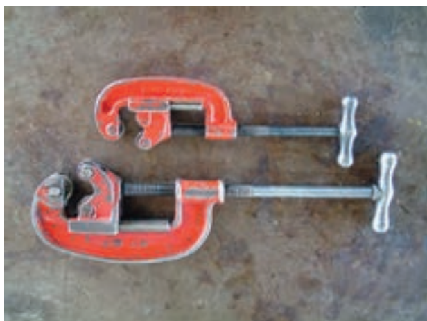
شکل ۱-۶۳- لوله‌بر در دو اندازه‌ی متفاوت
