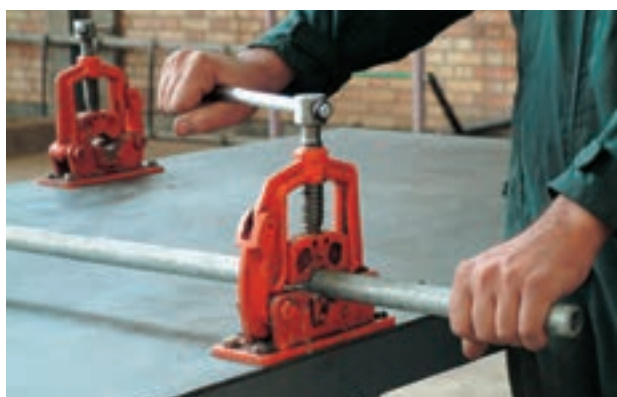
شکل ۳-۵۳- باز کردن شاخه‌ی لوله از گیره‌ی لوله
