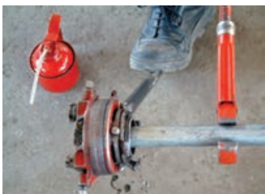
شکل ۱۲۳-۵- عمل باز کردن سردنده از پارچه‌های حدیده
