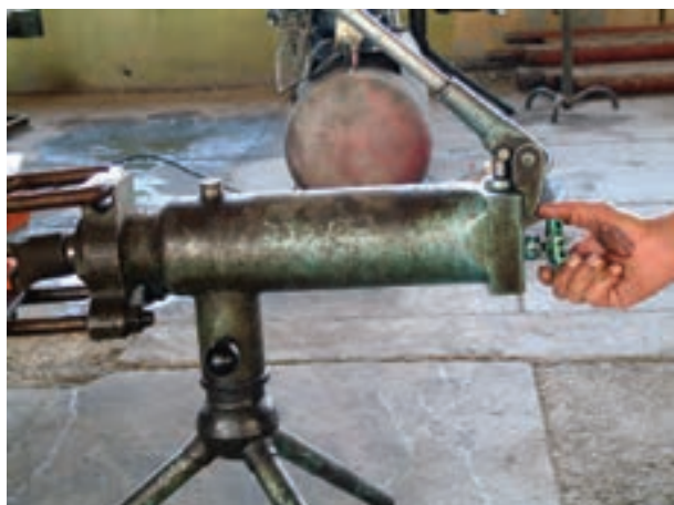
شکل ۳-۲۳- بستن شیر قطع و وصل
