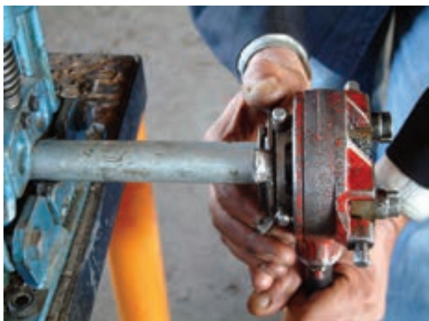
شکل ۴-۳۹- باز کردن فلک‌های چهارنظام
