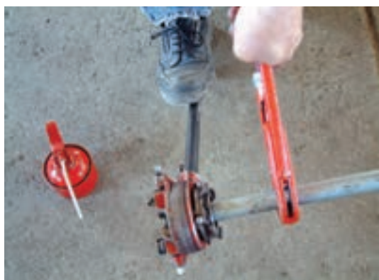
شکل ۱۲۰-۵- عمل حدیده کاری لوله
