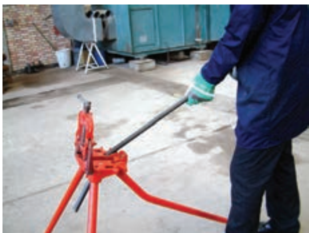
شکل ۳-۹- خم‌کاری لوله به وسیله‌ی گیره‌ی صحرایی
