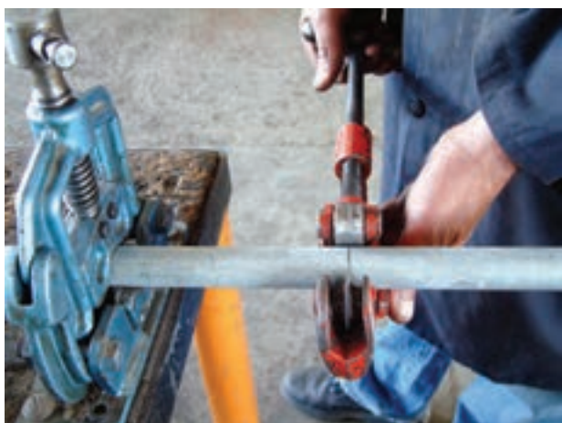
شکل ۱-۶۲- سفت کردن دسته‌ی لوله‌بر به اندازه‌ی لازم
