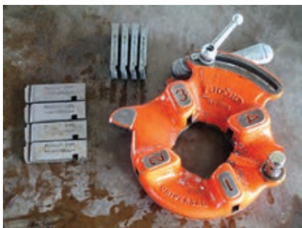
شکل ۸۹-۴- مشخصات حک شده بر روی پارچه‌های حدیده
