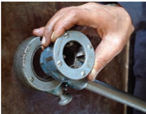
شکل ۴-۴۴- خارج کردن پارچه از بدنه‌ی حديد
