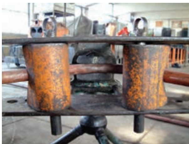
الف- باز کردن خم لوله‌ی خم شده
