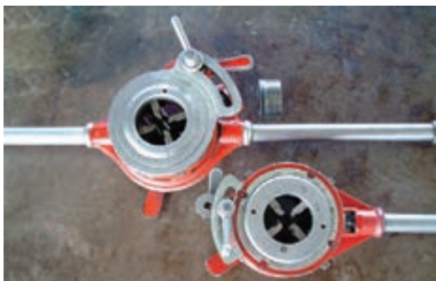
شکل ۴-۵۱- حديددهاى دستى چهارپارچهى يك دسته و دو دسته
