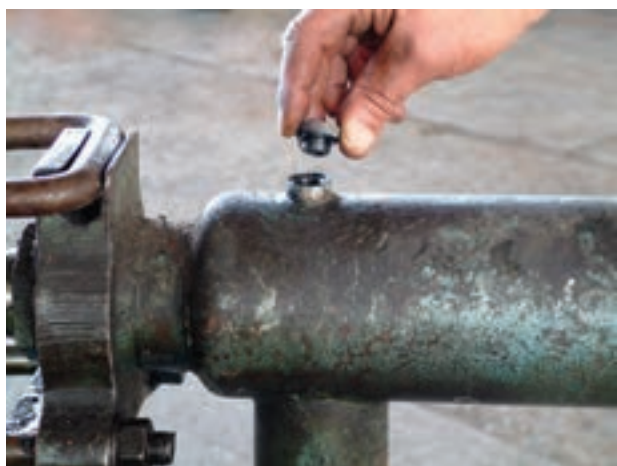
شکل ۳-۱۵ سرپوش مجرای ورودی روغن
