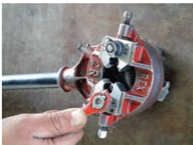
شکل ۴-۲۸- سفت کردن مهره به وسیله‌ی آچار حدیده
