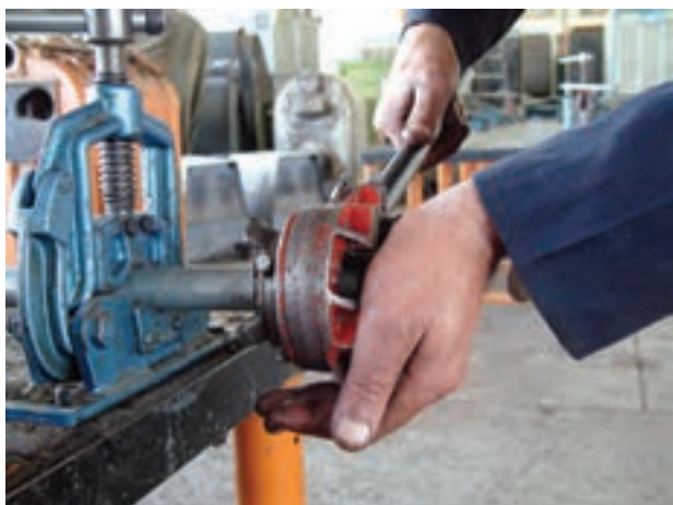
شکل ۴-۳۳- درگیر نمودن پارچه‌های حدیده با لوله
