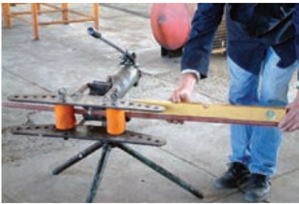
شکل ۳-۴۳- کنترل افقی بودن لوله در خم کاری
