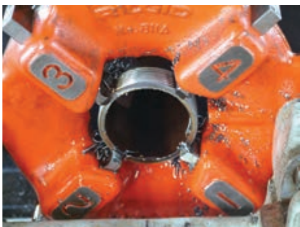
شکل ۴-۸۰- لوله در حال باز شدن از پارچه‌ها
