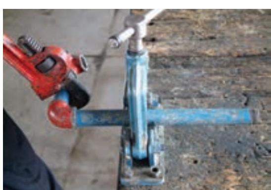
شکل ۱۵۴-۵-بستن لوله‌ی ضلع دوم مدار
