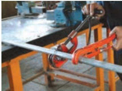
۲۶- چرا از آچار لوله‌گیر دو دسته در شکل رو به رو برای بریدن لوله استفاده شده است؟
