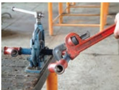
شکل ۵-۱۴۰—بستن ضلع دوم مدار مثلث شکل
