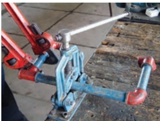
۸- ضلع سوم مدار را مطابق شکل ۵-۱۵۶ به وسیله‌ی دو عدد آچار لوله‌گیر به سه راهی  $90^\circ$  درجه بیندید.
