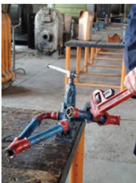
شکل ۵-۱۴۱—بستن یکی از قطعات به سه راهی
