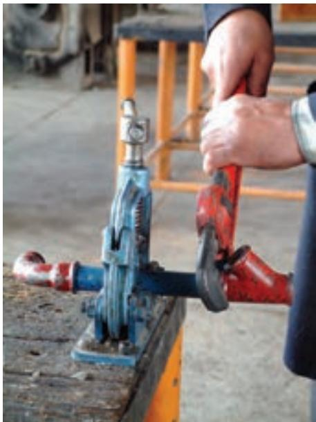
شکل ۵-۱۳۹—بستن فیتینگ‌ها به لوله‌های حدیده شده
