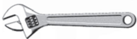
شکل ۱۲۰-۲- نمای ظاهری یک آچار فرانسه
