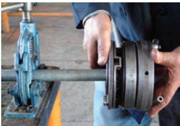
شکل ۵-۱۳۰- حدیده کردن لوله‌ها
