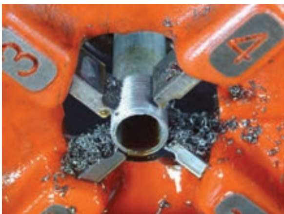
شکل ۴-۱۱۶- طول مناسب دنده
