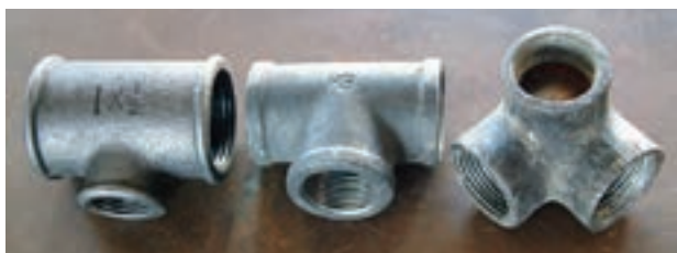
الف - سه راهی کنج، معمولی و تبدیلی
