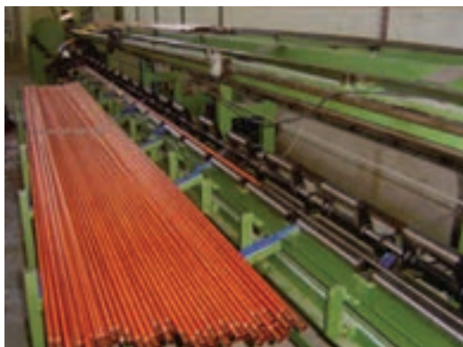
شکل ۵-۹- لوله‌ی مسی به صورت شاخه‌ای
