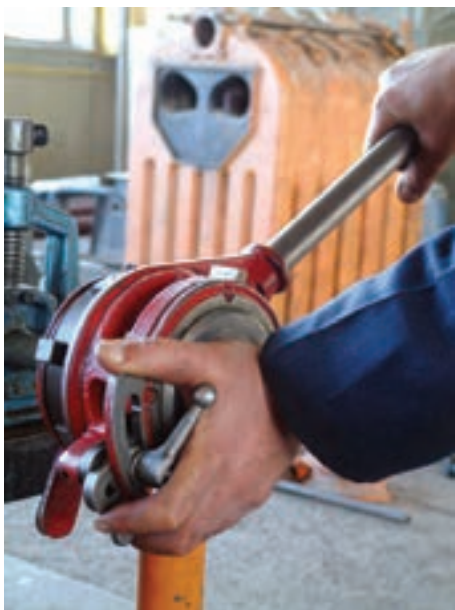
شکل ۴-۱۲۲- عمل درگیر کردن پارچه‌ها با سر لوله
