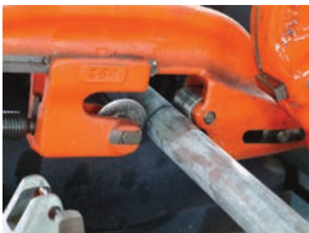
شکل ۴-۱۳۷- بریدن لوله به وسیله ی لوله بُر
