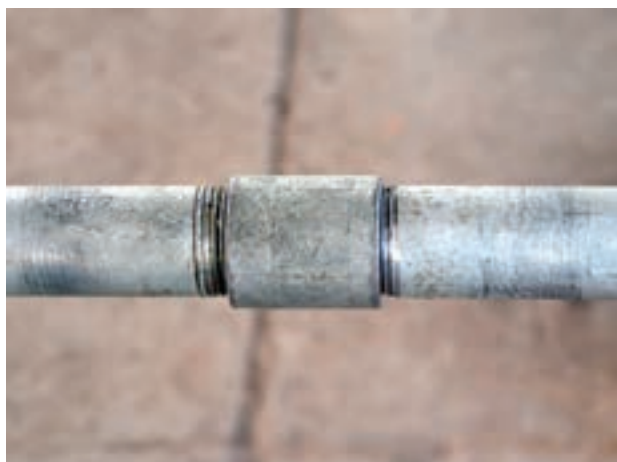
شکل ۳-۵- اتصال دنده ای
