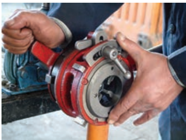
شکل ۴-۱۱۴- سفت کردن فلکه‌ی چهار نظام
