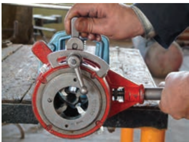
شکل ۱۲۵-۴ كم كردن بار پارچه‌هاي حديدك
