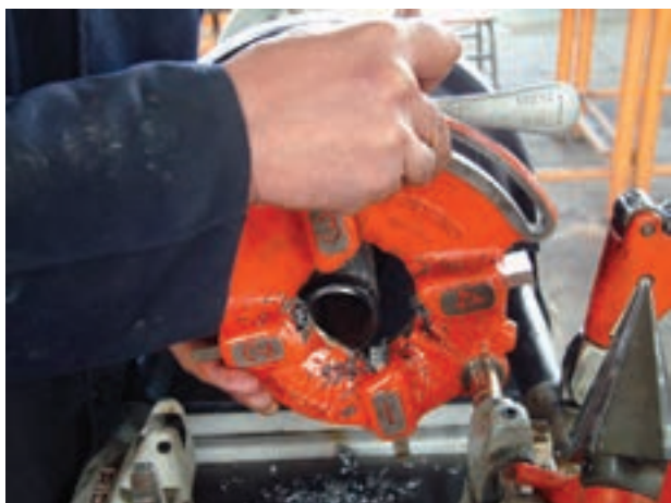
شکل ۴-۹۰ جدا کردن تنه‌ی حدیده از دستگاه
