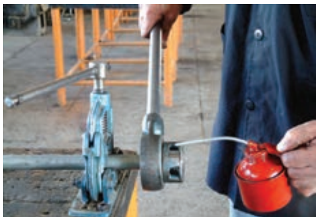
شکل ۴۹- روغن کاری محل تماس پارچه‌ها با لوله
