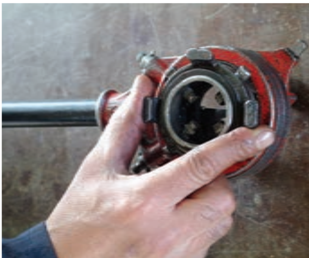
شکل ۴-۲۱- فلکه‌ی چهار نظام حدیده‌ی دستی دو پارچه
