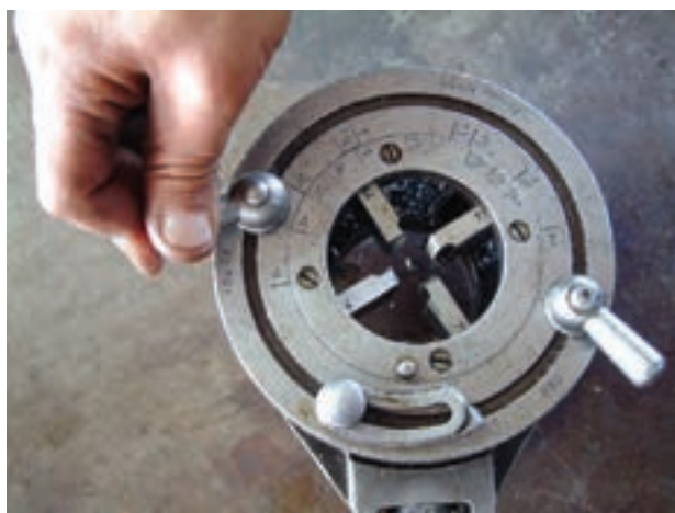
شکل ۴-۶۲- سفت کردن مهره‌های ثابت کننده‌ی رینگ متحرک
