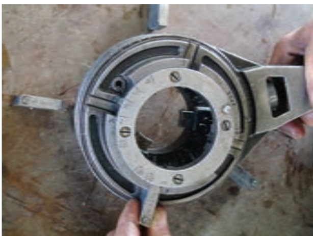
شکل ۴-۵۹- خارج کردن پارچه‌ها از حدیده
