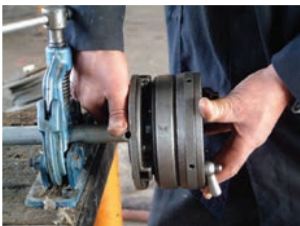
شکل ۴-۶۴- سفت کردن سه نظام حدیده
