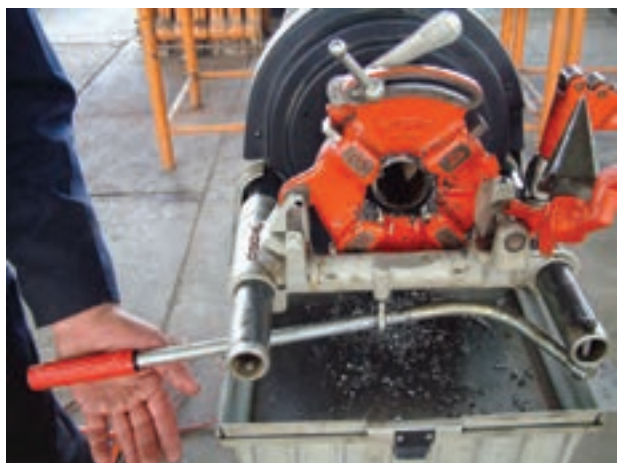
شکل ۴-۹۸ — کشیدن اهرم به عقب پس از حدیده‌کاری
