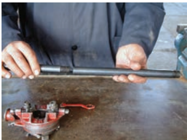
شکل ۴-۲۴ اتصال دسته‌ی دو تکه به یک‌دیگر
