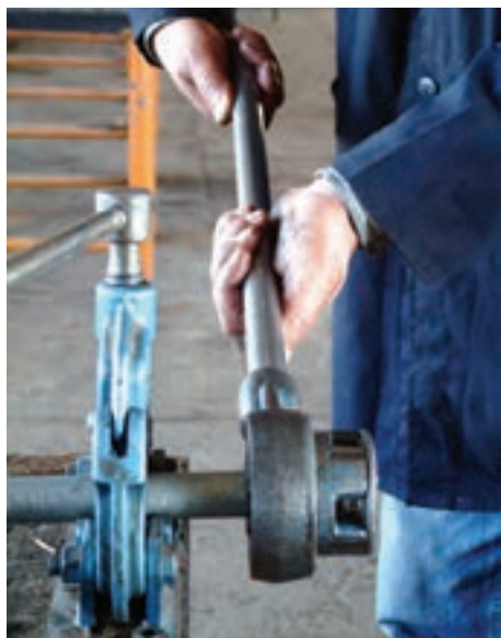
شکل ۵۰- باز کردن حدیده از لوله
