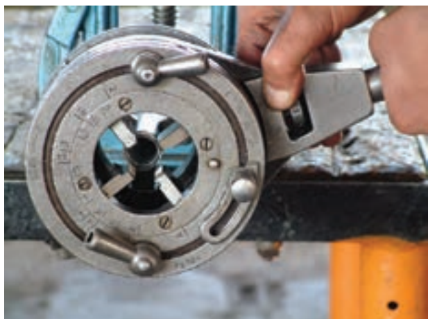
شکل ۴-۵۶- قرار دادن ضامن در حالت F
