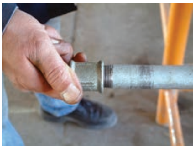
شکل ۴-۴۱- کنترل بار سردنده به وسیله‌ی یک فیتینگ
