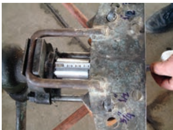
شکل ۳-۲۷- اندازه‌گیری طول پیستون خارج شده از سیلندر
