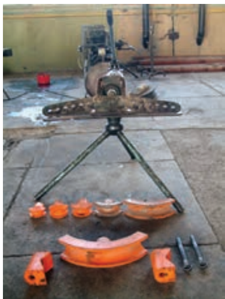
شکل ۳-۱۳ اجزای خم کن هیدرولیکی
