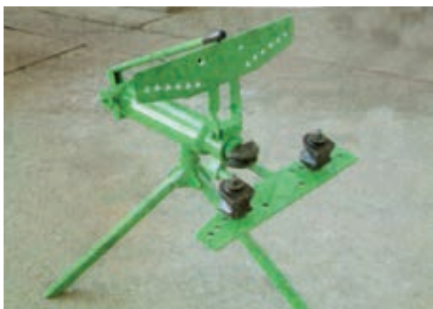
شکل ۳-۴۸- قرار گرفتن لقمه در محل مناسب خود
