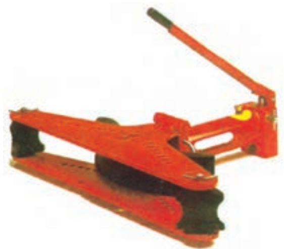
شکل ۱۰-۳- خم کن هیدرولیکی
