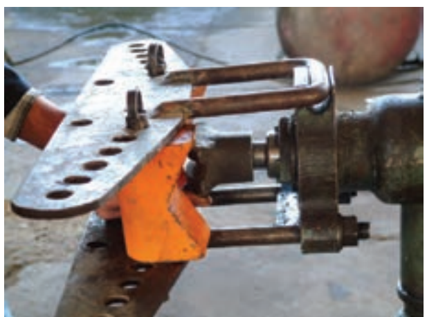
شکل ۳-۵۵ قرار دادن پارچه‌ی خم کن \frac{3}{4} و لقمه‌ها در جای خود
