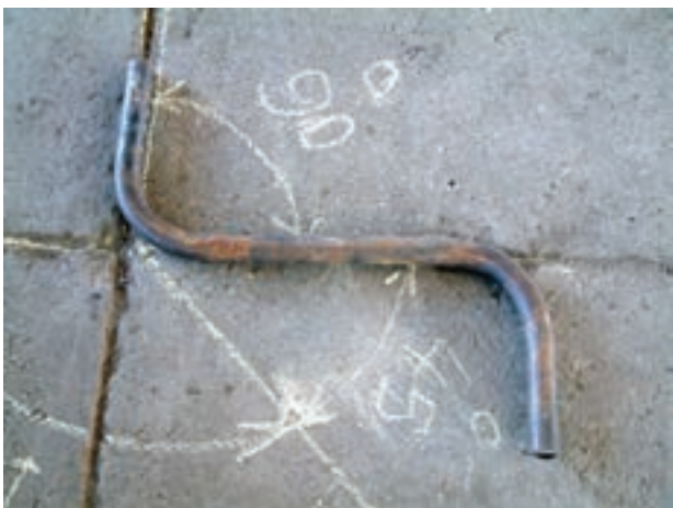
شکل ۵۸-۳- ادامه ی عمل خم کاری
