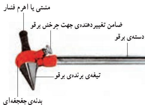
شکل ۲-۹- اجزای بُرقوی جفجغه‌ای
