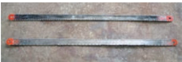
شکل ۱-۴۰ از بین رفتن دندانهای تیغه اژه
