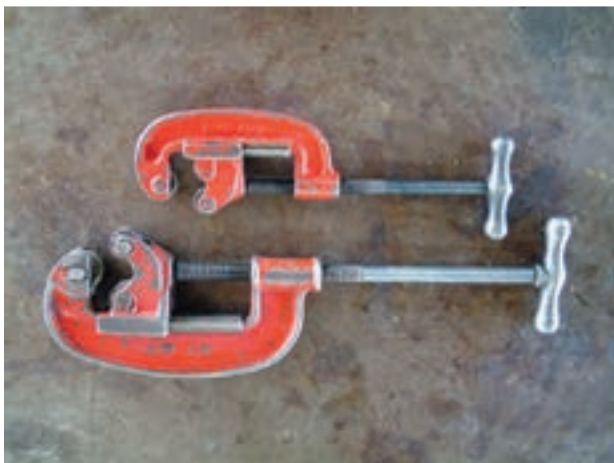
شکل ۱-۶۳- لوله‌بر در دو اندازه‌ی متفاوت
