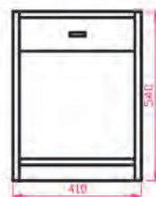
نمای کابینت پاتختی بدون در، با جعبه و با پاستنگ (عمق ۳۰۰)
