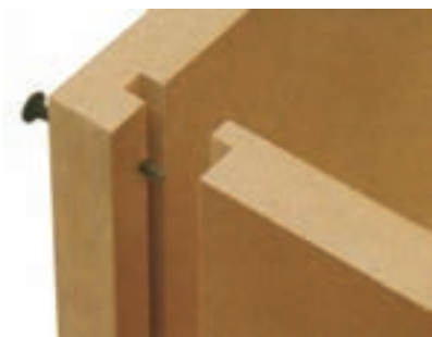
شکل ۲-۳۴-۲ تصویر مجسم پشت‌بند دو راهه شده که داخل کنشکاف، با پیچ محکم می‌شود.
