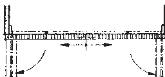
شکل ۲-۵۸- درهای کشویی آویخته در برش طولی و نمای روبه‌رو.
