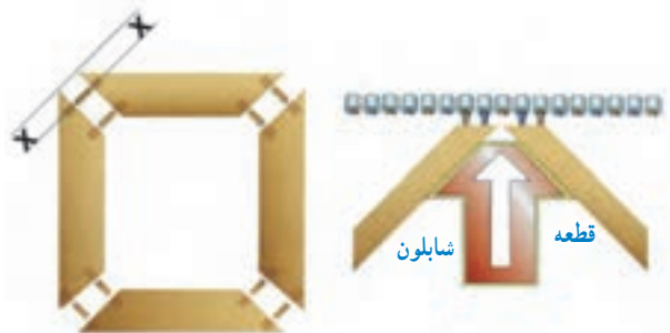
شکل ۱۶-۲- ب- روش ساخت اتصال قاب فارسی، به وسیله دوبل زن ماشینی
