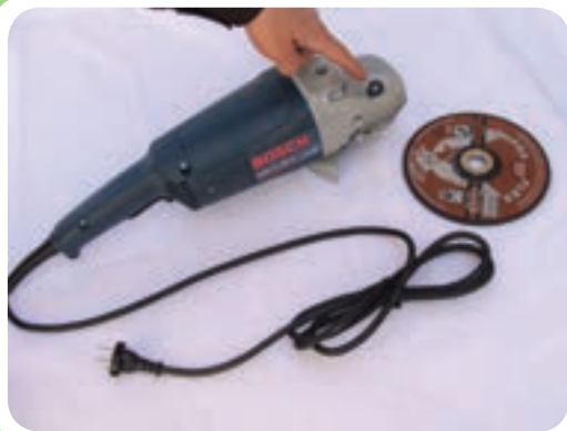
کلید مخصوص قفل کردن محور سنگ
