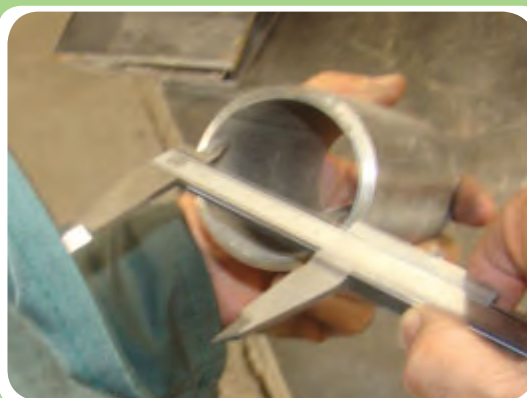
اندازه‌گیری قطر داخلی لوله توسط کولیس
