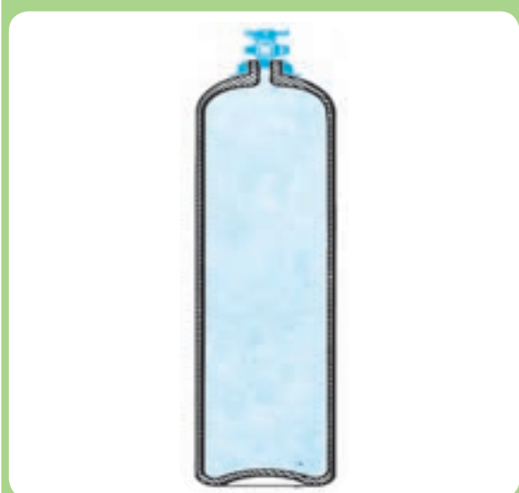
کپسول فولادی مخصوص برای ذخیره اکسیژن
