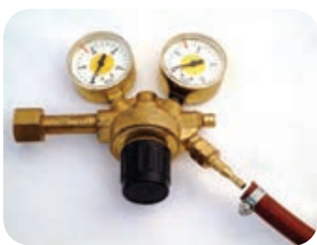
اتصال شیلنگ به رگولاتور گاز
