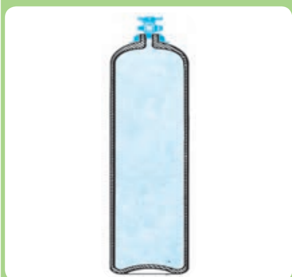
کپسول فولادی مخصوص برای ذخیره اکسیژن
