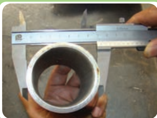
اندازه‌گیری قطر خارجی لوله توسط کولیس
