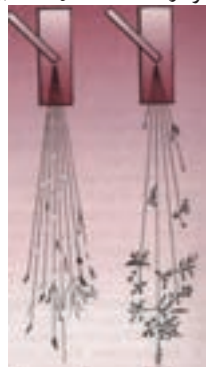
جرقه های ناشی از سنگ زدن روی فولادهای منگنز دار و تندبر
