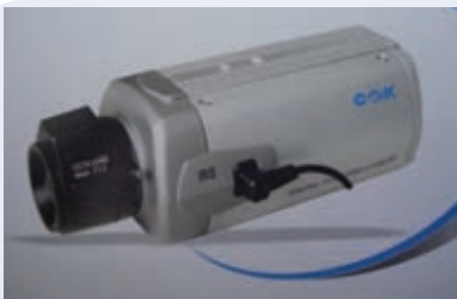
شکل ۳-۲۲ اتصال کابل لنز اتوایریز به دوربین
