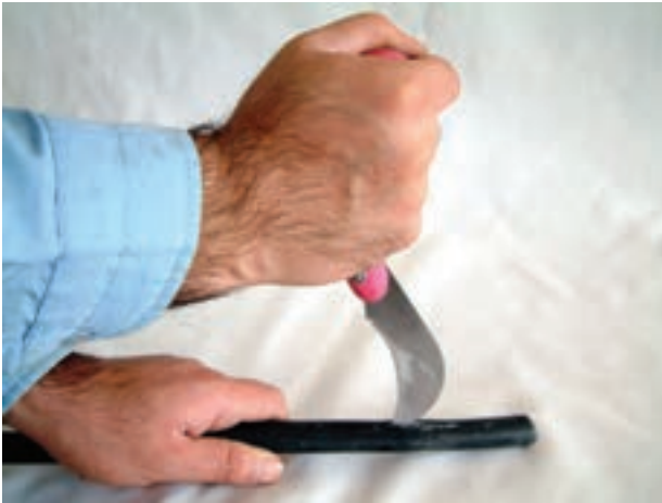
الف - نحوه‌ی غلط لخت کردن کابل
