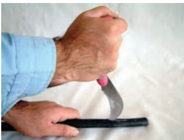
شکل ۳۲-۵- روکش برداری غلط
