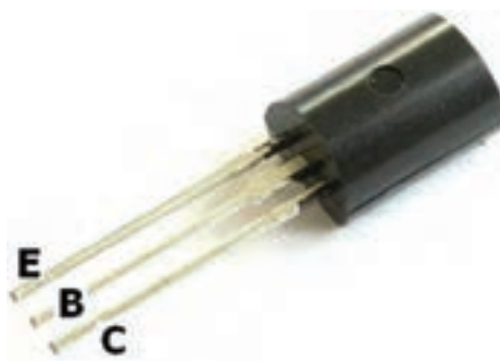
شکل ۸-۲- پایه‌های ترانزیستور
