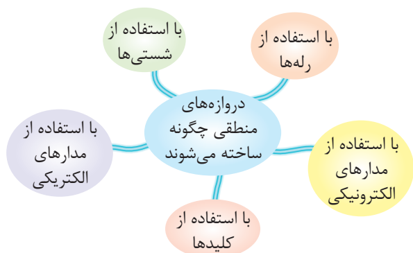
شکل ۱۷-۴- وسایل مورد استفاده در ساخت دروازه‌های منطقی
