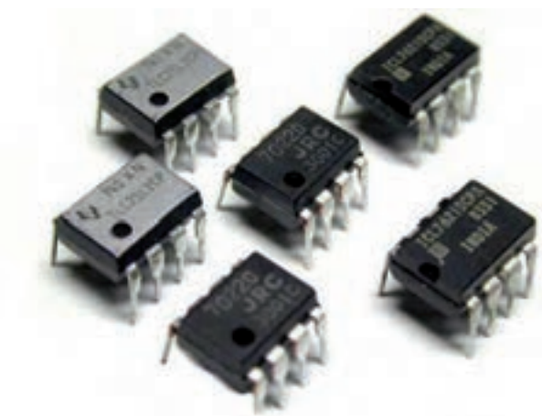
شکل ۴-۵۶- چند نمونه آی سی دروازه منطقی
