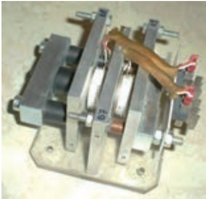
شکل ۳-۳- تریستورهای دیسکی همراه با گرماگیر
