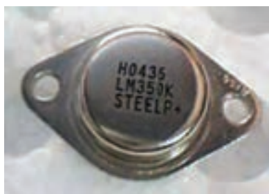
شکل ۵۵-۱- آی سی رگولاتور قابلمه ای
