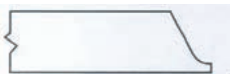
حالت لبه J شکل یکطرفه
