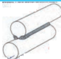
جوش شیاری V شکل لبه برگردان دوطرفه
