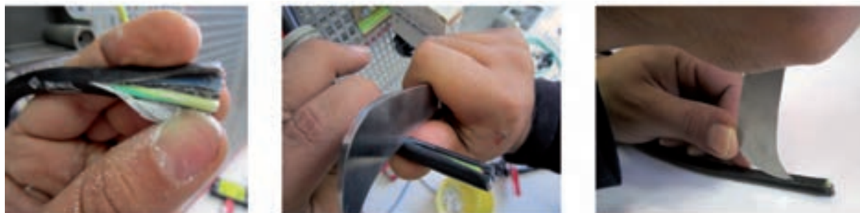
شکل ۲-۲۲ - بریدن و لخت کردن کابل
