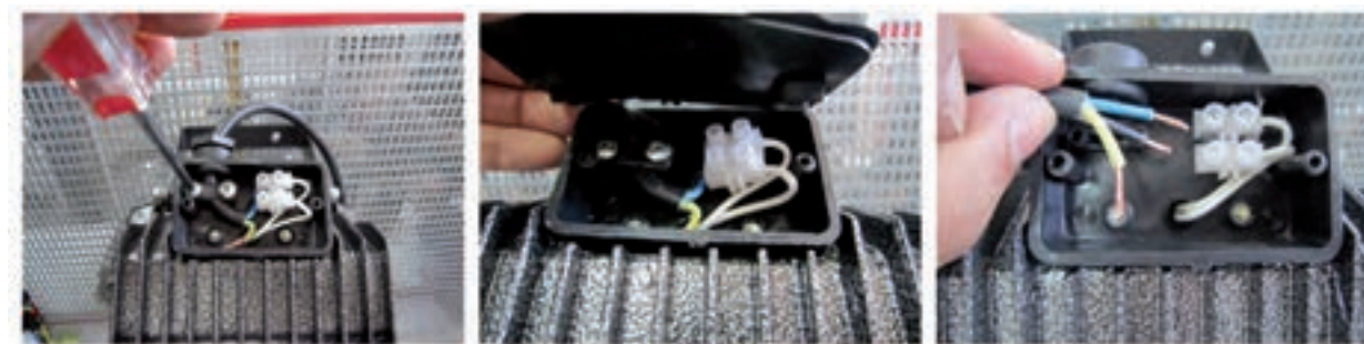
شکل ۲-۲۵ - سیم کشی در جعبه اتصالات
